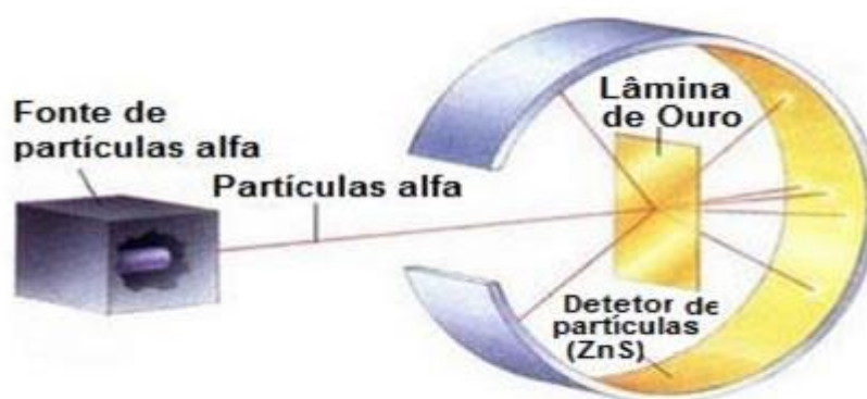
Imagem 21 - Representação do experimento de Rutherford. Observe que algumas partículas alfa sofreram um desvio considerável.
