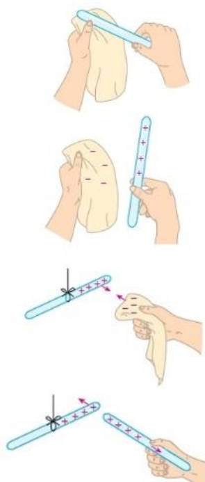
Imagem 9 - Bastão de vidro atritado com um pedaço de seda atrai a própria seda, por exemplo, ou uma bolinha de papel; repele outro bastão de vidro eletrizado por atrito.
