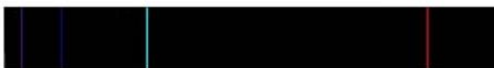
Imagem 36 - Espectro de linhas do elemento hidrogênio.
