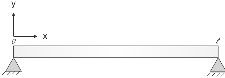
Figura 48- Representação de uma viga biapoiaada.
