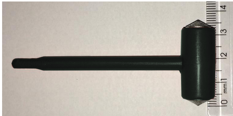
Figura 22- Martelo utilizado para gerar impactos na estrutura.
