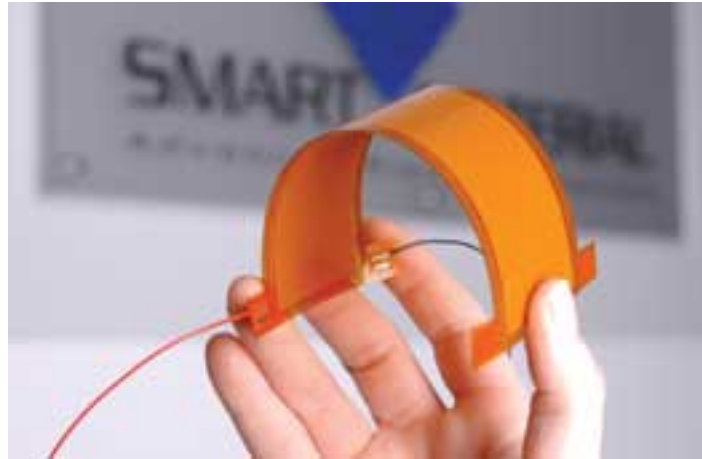
Figura 7- Transdutor Macro Fiber Composite , demonstrando elevada flexibilidade.
