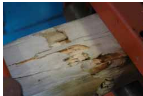
Figura 27: Ensaio de tração paralela, A. antes e B. depois de aplicada a carga.
