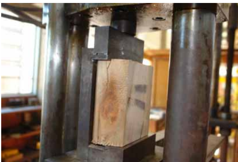
Figura 35: Corpo de prova de cisalhamento após a ruptura.
