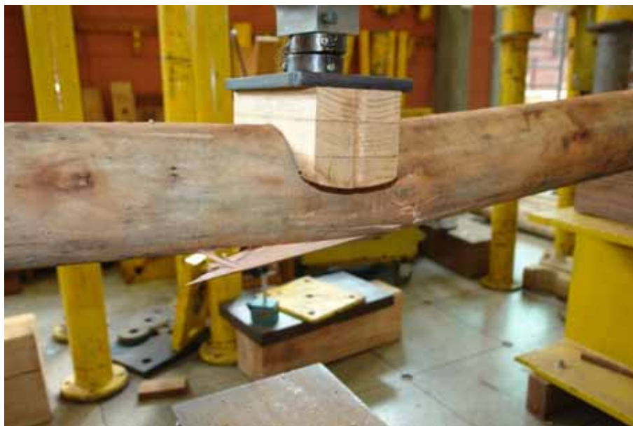
Figura 21: Detalhe do corpo de prova rompido onde observa-se a presença de um nó na região carregada.
