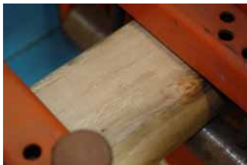
Figura 27: Ensaio de tração paralela, A. antes e B. depois de aplicada a carga.
