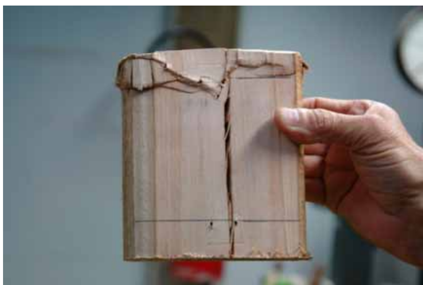
Figura 31: Corpo de prova após ser realizado o carregamento até a ruptura.
