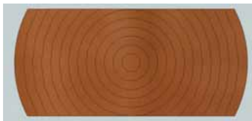
Figura 24: Vista da seção transversal do corpo de prova usado no ensaio de tração
