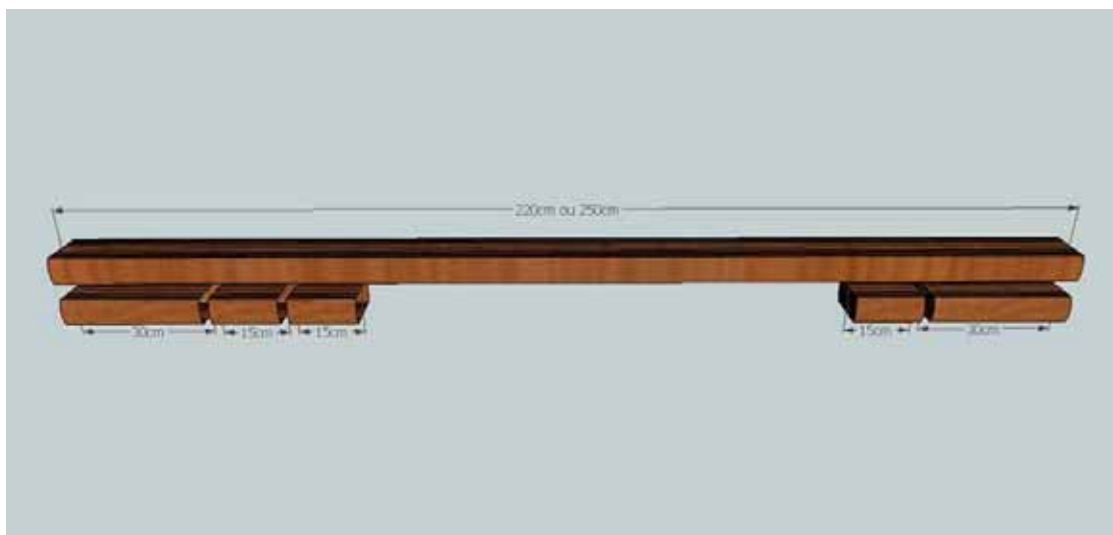
Figura 23: Esquema utilizado para confecção dos corpos de prova de compressão e cisalhamento a partir da peça ensaiada na tração.
