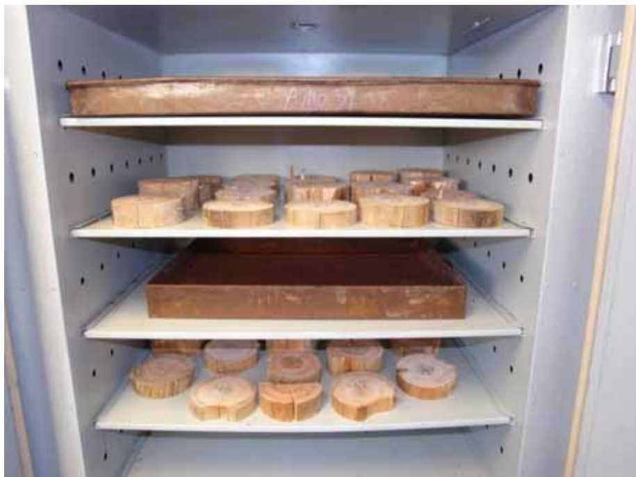
Figura 17: Disposição dos discos de madeira na estufa, ensaio de umidade.
