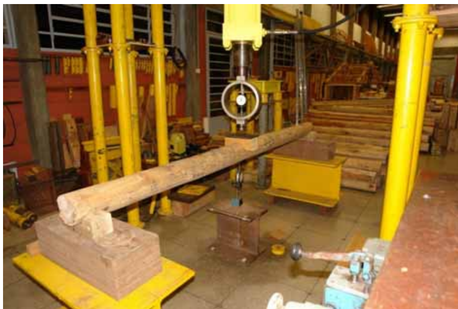
Figura 19: Peça roliça de madeira sendo ensaiada na flexão estática.
