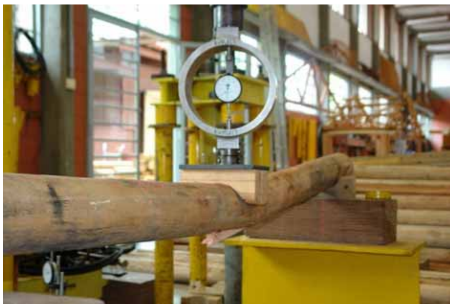
Figura 20: Indicação da carga de ruptura no anel dinamométrico.
