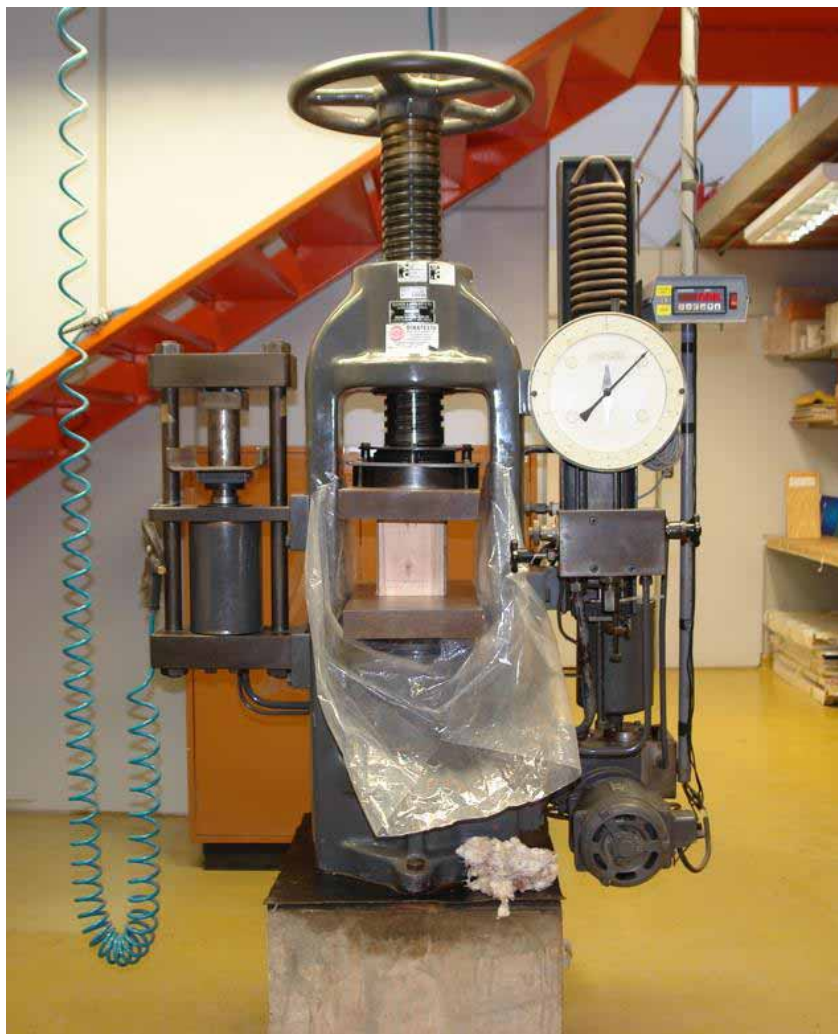
Figura 30: Ensaio de ruptura na compressão paralela às fibras.
