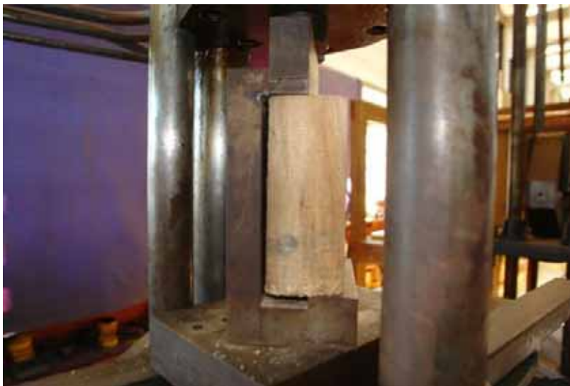
Figura 34: Ensaio de cisalhamento evidenciando o dispositivo utilizado.
