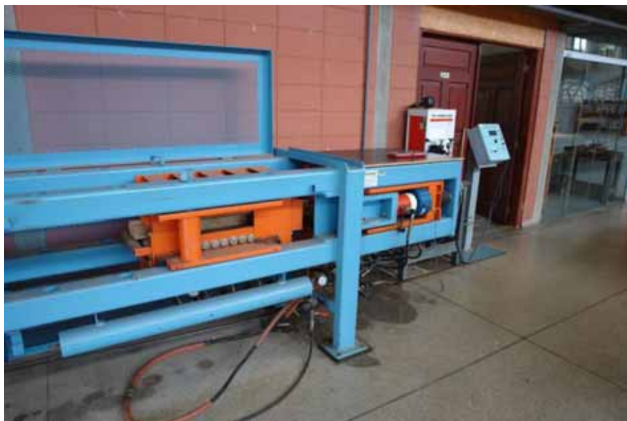
Figura 26: Máquina utilizada nos ensaios de tração paralela às fibras.
