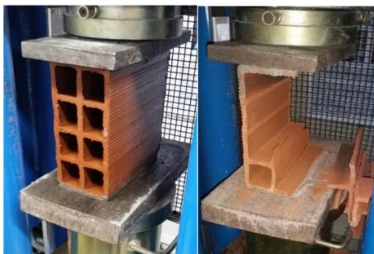
Figura 10 – Ensaio de resistência à compressão em bloco cerâmico
