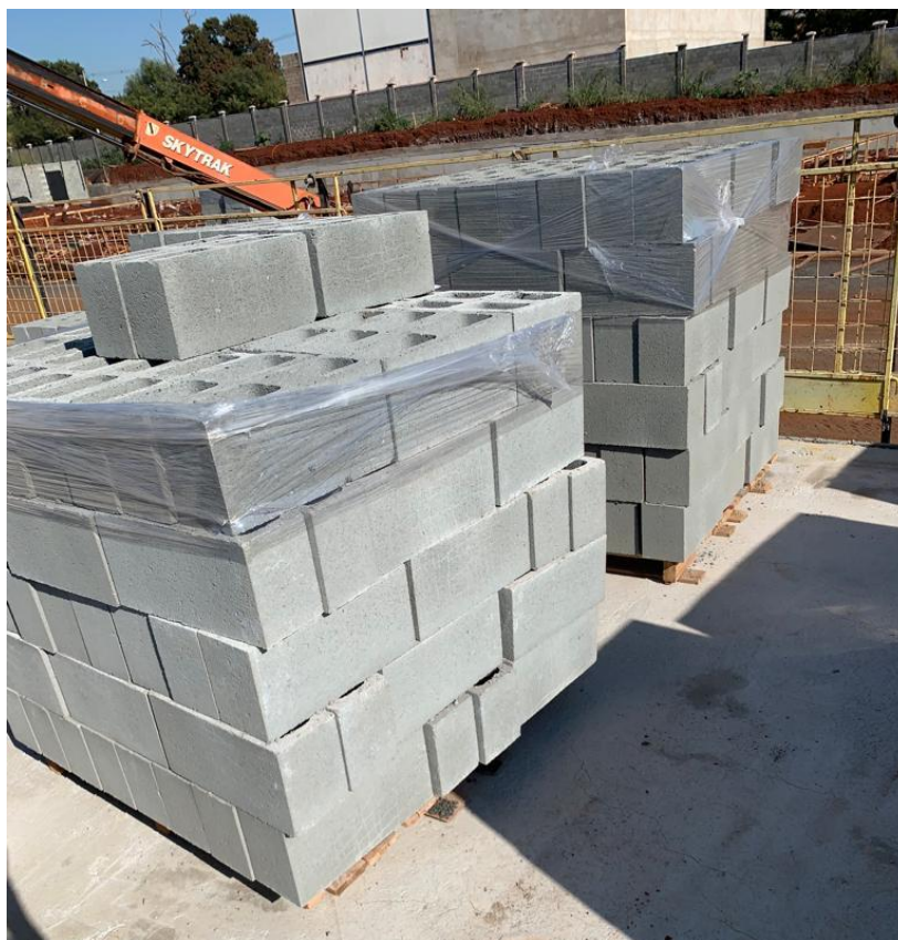
Figura 12 – Blocos de concreto
