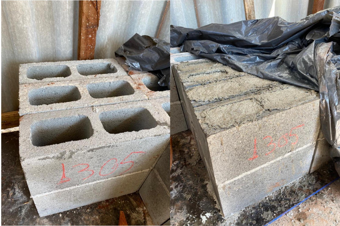
Figura 14 – Prismas cheio e oco de bloco de concreto
