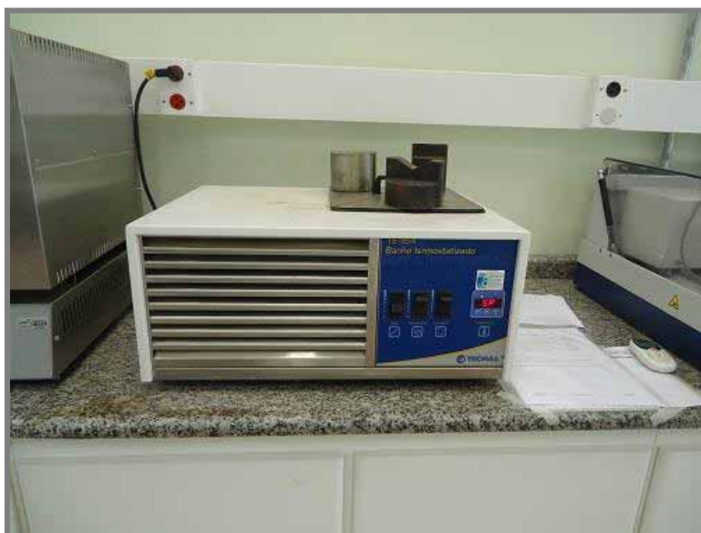
Figura 9 – Banho termostatizado marca Tecnal TE-184
