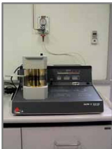
Figura 18 – Equipamento Supter Coater , Baltec , modelo SCD 050
