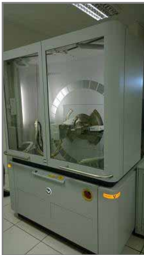
Figura 19-Difratômetro marca Panalytical, modelo Empyrean
