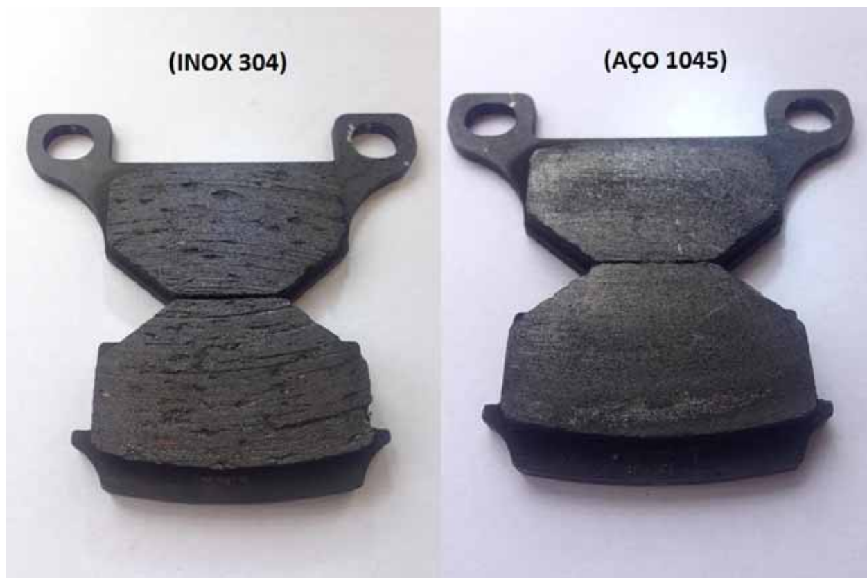
Figura 9 – Estado Final das Pastilhas de Freio
