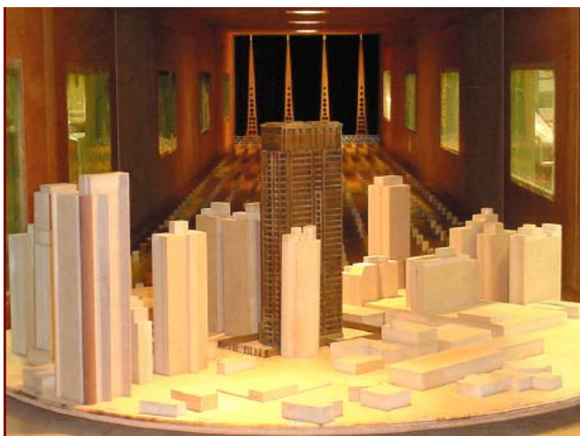
Figura 3 – Modelo Reduzido do Edifício. Fonte: Loredo-Souza (2004)
