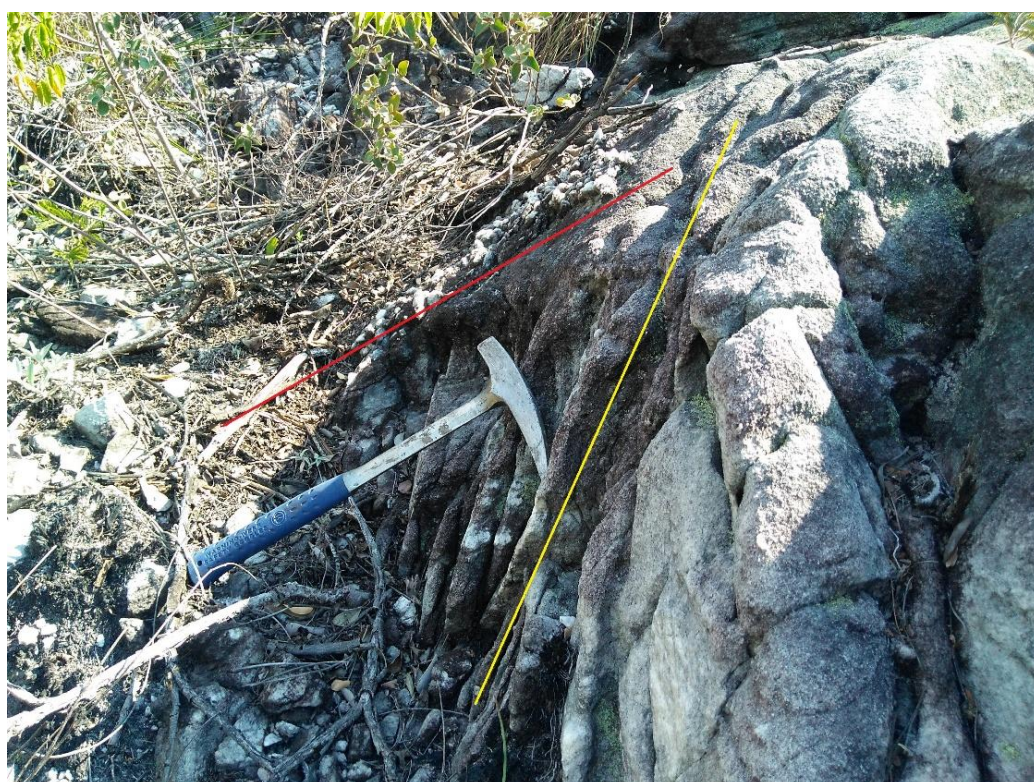
Figura 5.16- So marcado pelo traço vermelho (contato entre metaconglomerado (acima da linha) e quartzito, atitude =96/43) e Sn marcado pelo traço amarelo (atitude=94/82). Ponto SCO-337 (X=334865, Y= 8757381 e Z= 753), visada para o rumo 200.
