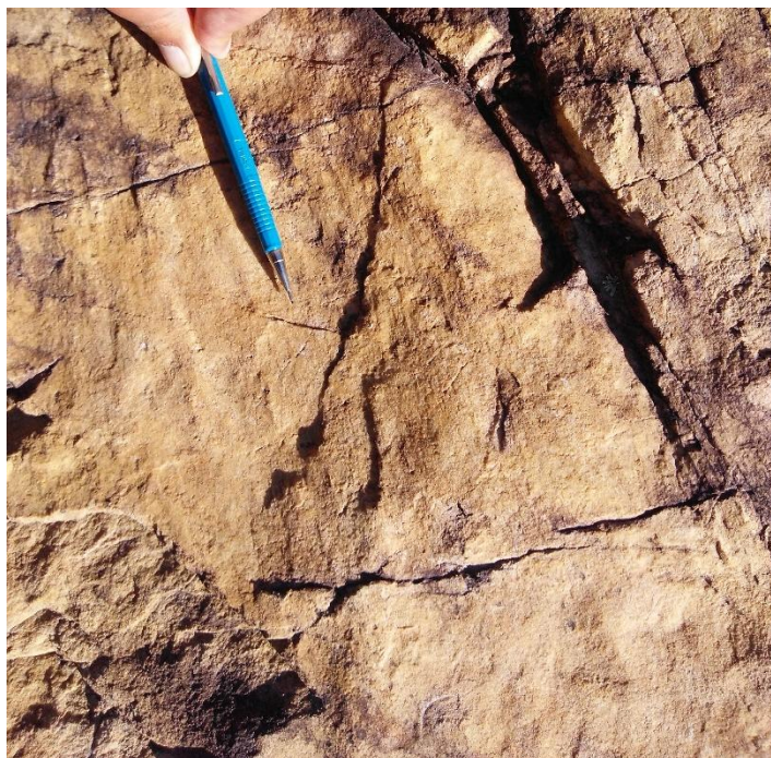
Figura 5.32 – Quartzito da unidade Quartzito Superior da Formação Serra Do Córrego mostrando estrias de falha em plano 353/79, observadas no ponto SCO-304 (X=335090; Y=8758033 e Z=598) - visada S.
