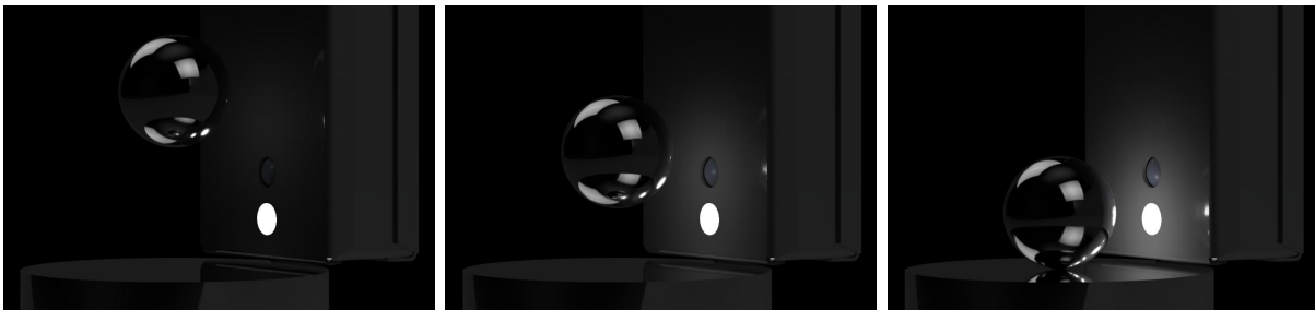
Figura 31 – Variação da luminosidade sobre o sensor fotoelétrico, em função da posição da esfera metálica durante sua queda livre. Fonte: Autor.
