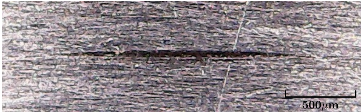
Figura 44 – Risco feito com profundidade de corte programada a_p = 10 \mu\text{m} . Fonte: Autor.
