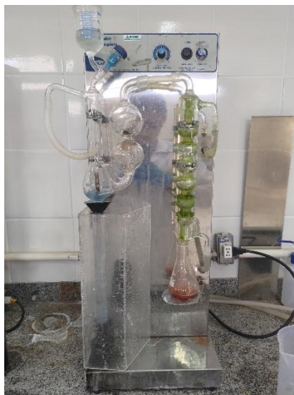
Figura 6 - Processo de destilação das amostras digeridas.
