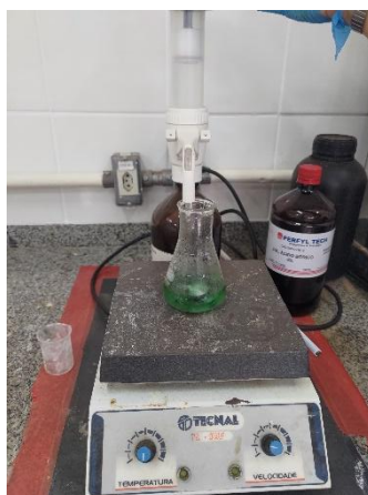
Figura 7 - Bureta eletrônica com a solução ainda na coloração esverdeada.
