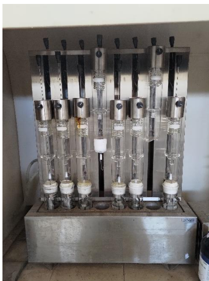
Figura 8 - Lavagem das amostras em éter de petróleo no extrator Soxhlet.
