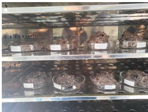
Figura 3 - Carcaças processadas em placa de petri dentro da estufa a 50°C.
