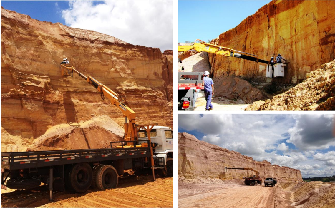
Figura 3: Momento do levantamento das seções colunares, que exigiu o auxílio do caminhão munck e da ajuda de profissionais qualificados que monitoraram a atividade.
