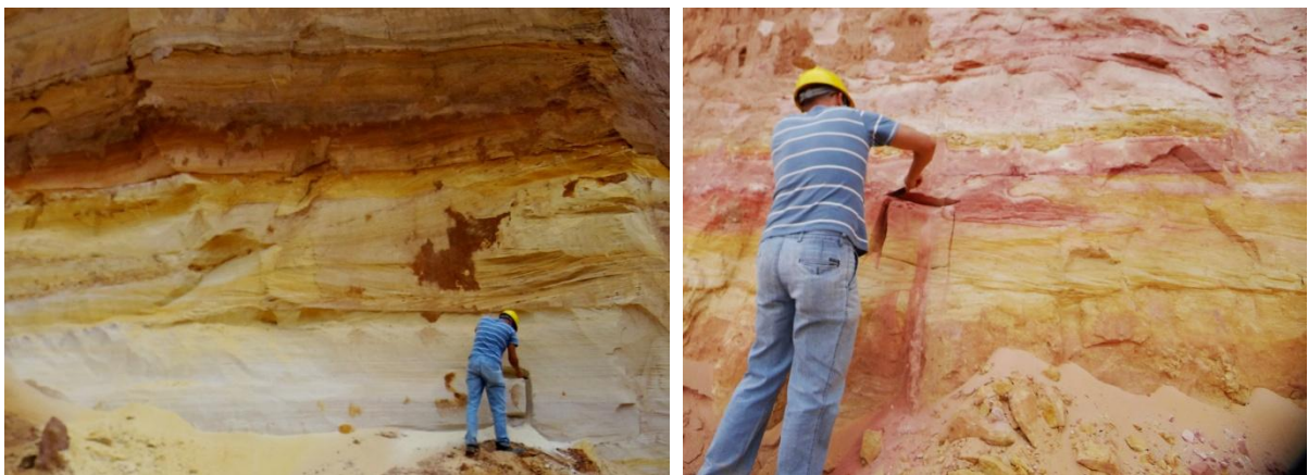
Figura 4: Momento da coleta de amostras, em forma de cubos de aprox. 20 cm de lado, “recortados” e liberados da frente de lavra com o auxílio de uma espátula.
