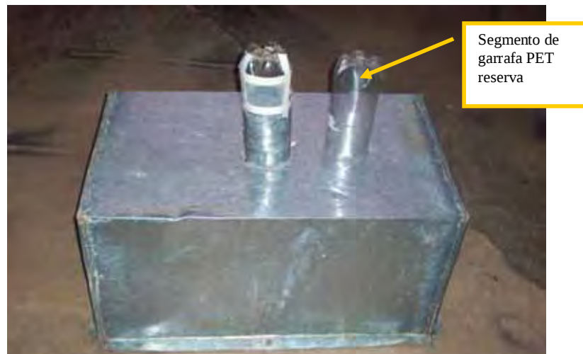
Figura 30. Modelo de urna entomológica com 80 cm na face maior e 45 cm de profundidade e largura. No centro o bocal para adaptar o coletor, que pode ser uma garrafa PET transparente, tendo outra secção de garrafa PET ao lado para imediata reposição. Quanto maior e abrangente a urna, maior capacidade de capturar insetos que dispersam para pupariação.
