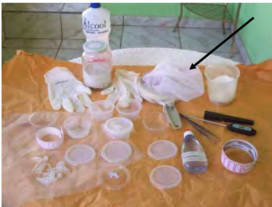
Figura 28. Material mínimo para trabalhos entomológicos de campo para perito criminal. Assinalado um puçá entomológico adaptado com organza a partir de uma peneira de tamanho médio. Também se observam os potes plásticos com tampa e fragmento de organza, ependorf, etiquetas adesivas, termômetro digital com haste que mede inclusive a temperatura anal no cadáver, pinça, algodão, luvas, frasco de vidro adaptado como “câmara mortífera” de alados e solução de álcool 70 e 93% ou éter.
