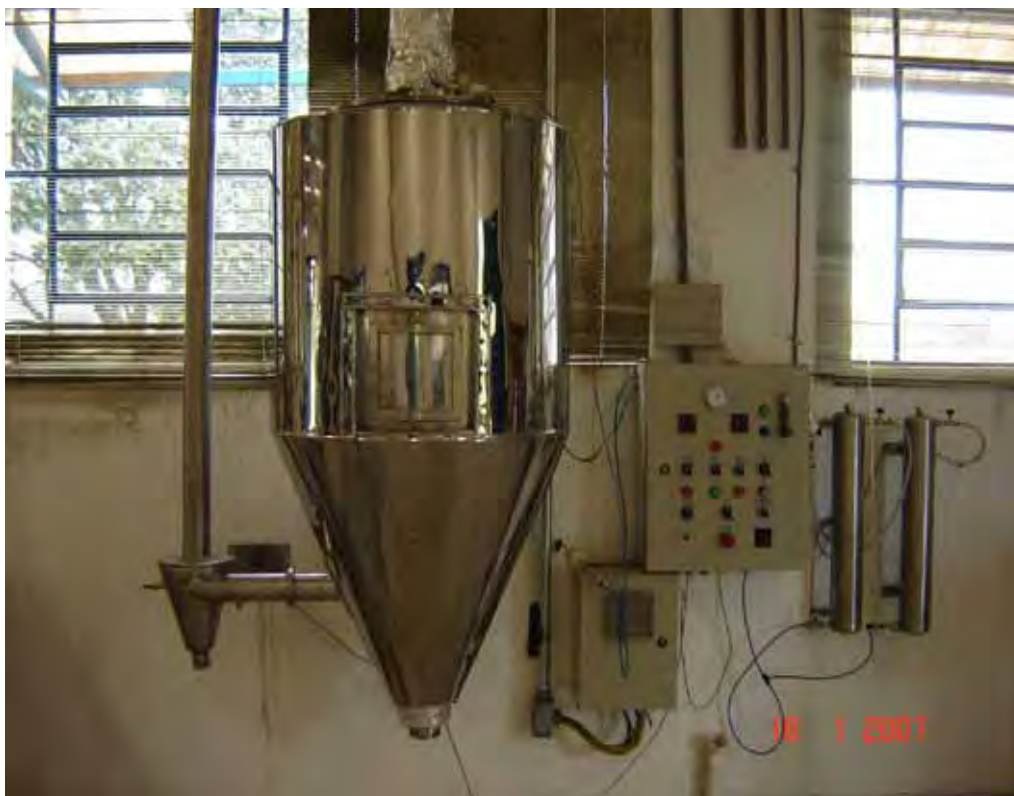
Figura 10. Secador tipo “spray-dryer” utilizado na secagem do extrato desidratado de yacon.
