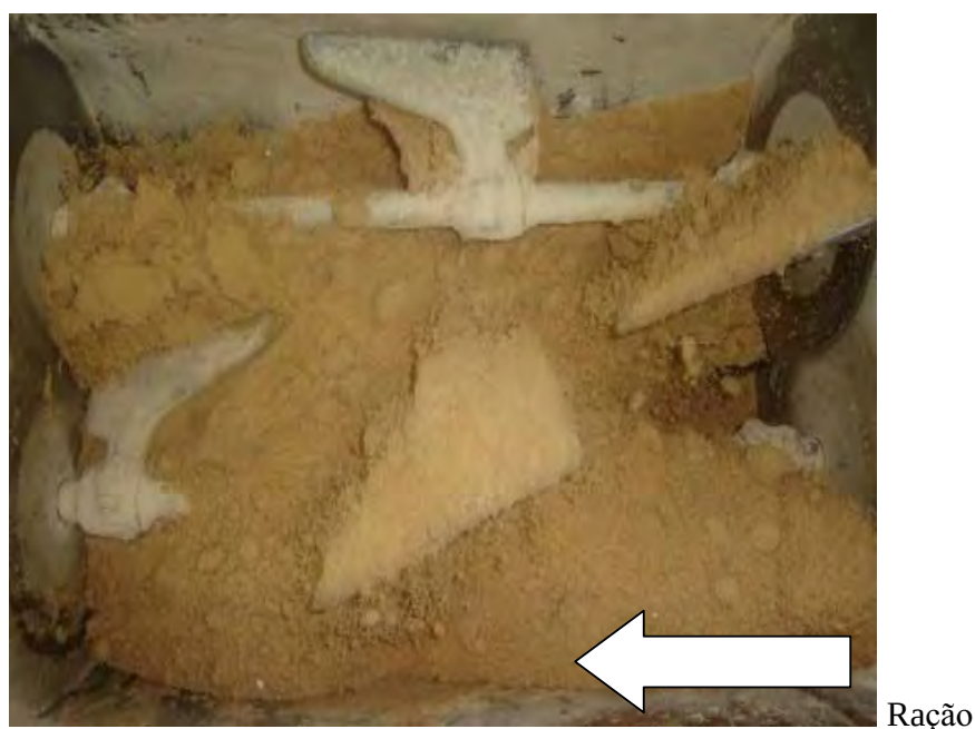
Figura 11. Misturador industrial CAF – Modelo M60.
