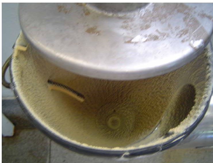
Figura 18. Extrato desidratado de yacon arrastado para o ciclone de descarga.
