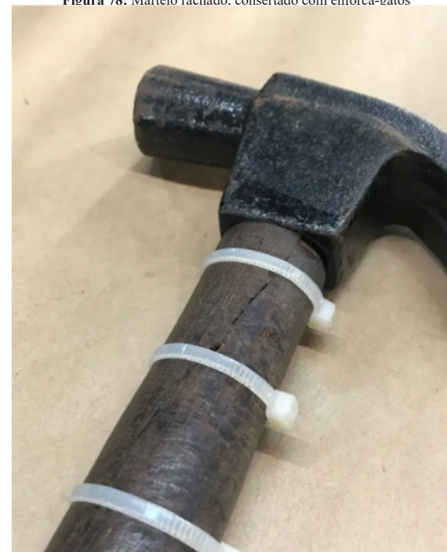
Figura 78: Martelo rachado, consertado com enforca-gatos
