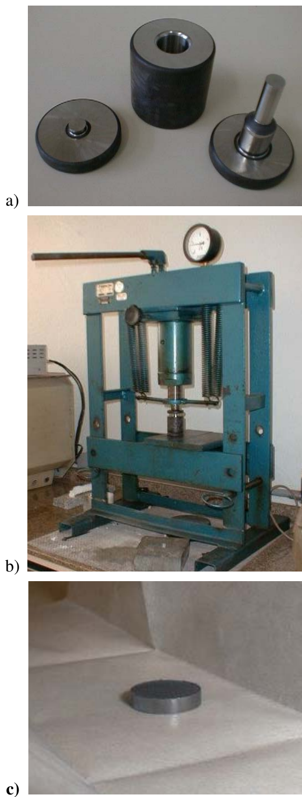
Figura 3: a) Molde de aço, b) prensa hidráulica e c) pastilha sensora.
