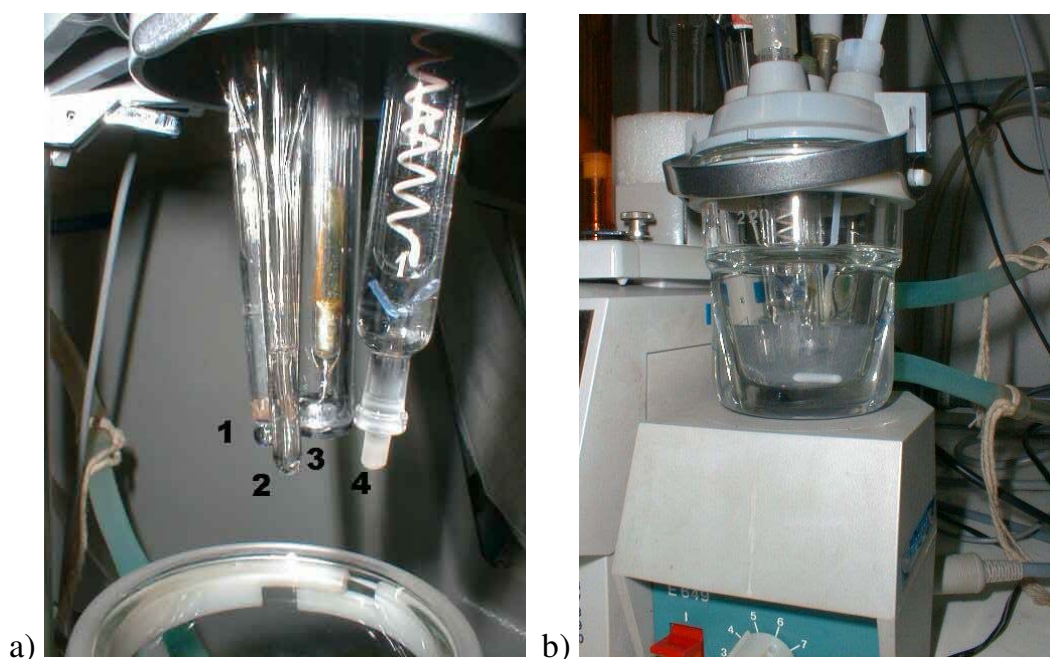
Figura 6: a) Célula potenciométrica aberta: 1) eletrodo de vidro combinado (para acompanhamento do pH durante os experimentos), 2) sonda de temperatura “Metrohm” Pt100 (para acompanhamento da temperatura durante os experimentos), 3) eletrodo indicador Pt|Hg|Hg 2 Ox|Grafite e 4) eletrodo de referência Ag|AgCl|Cl - de dupla junção (associado à ponte salina); b) célula potenciométrica termostatizada fechada.
