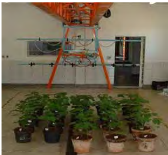
Figura 17. Detalhe do simulador de pulverização utilizado.
