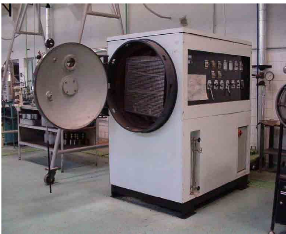
Figura 4. Vista do painel de comandos e controles da Autoclave Stock 900
