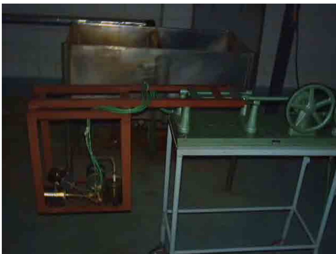
Figura 2. Detalhe do pórtico com latas testes e cabos termopares
