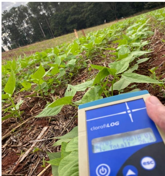
Figura 5. Aferição indireta do N com clorofilômetro portátil. Selvíria – MS, 03 de junho de 2024.
