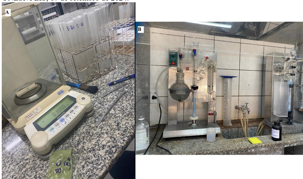
Figura 14A. Medição de folhas moídas (100 g) e 14B. Análise de N foliar após medição. UNESP/FEIS, 17 de setembro de 2024.
