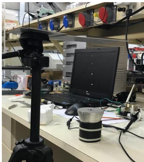
Figura 52: Estabelecimento da onda estacionária com uso de anteparo fixado ao tripé e a levitação de 6 esferas de isopor.
