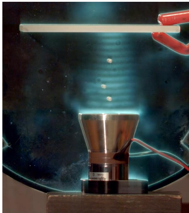
Figura 13: Ondas estacionárias evidenciadas pelo efeito schilieren
