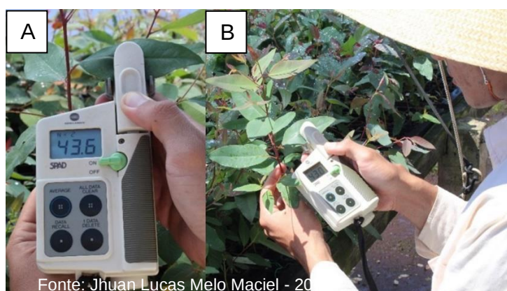
Figura 16 – Medidor portátil Chlorophyll Meter, Modelo SPAD-502 (A); obtenção das leituras realizadas nas folhas do terço médio das mudas de Eucalipto produzida em diferentes microambientes (B)
