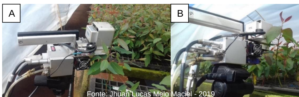
Figura 17 – Mudas selecionadas para avaliação da fração de lixiviação (A); Balança eletrônica utilizada para obtenção da massa do conjunto de tubete, muda, saco plástico com elástico (B)
