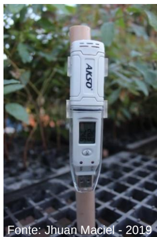
Figura 8 – Datalogger à prova d'água da marca Akso, modelo AK174 fixado em suporte no canteiro suspenso a pleno sol
