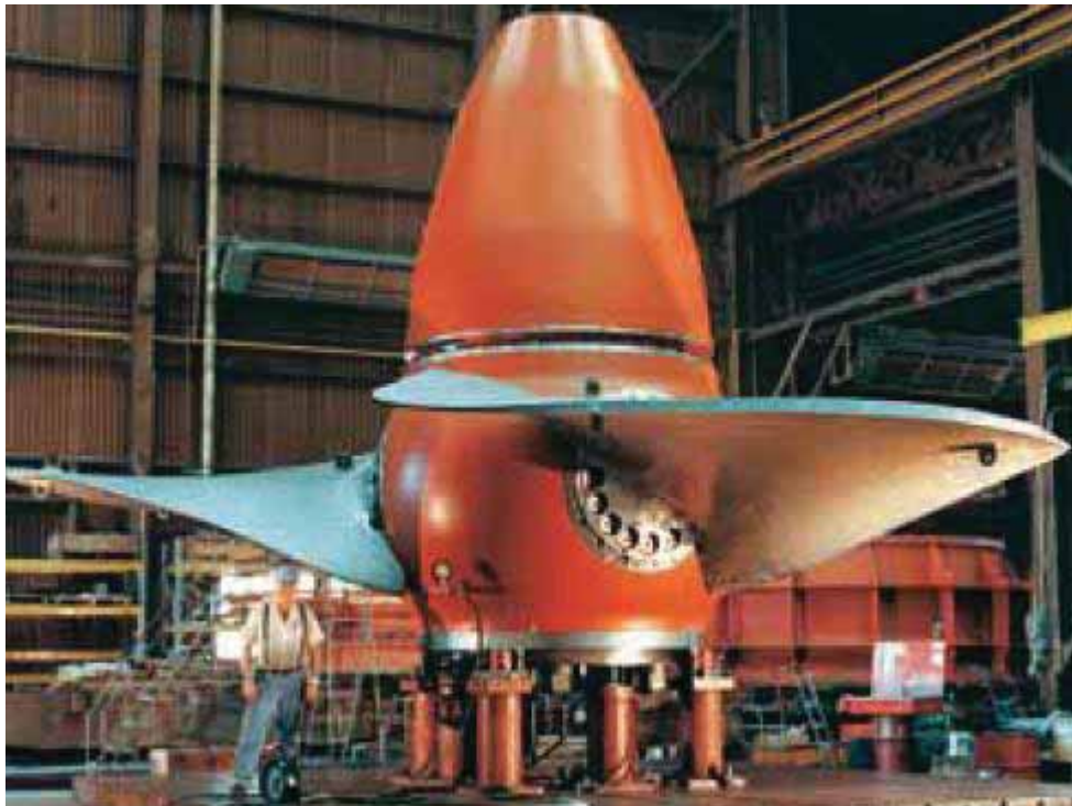
Figura 14 – Roda da turbina Bulbo da usina de Murray/USA em fase de montagem.
