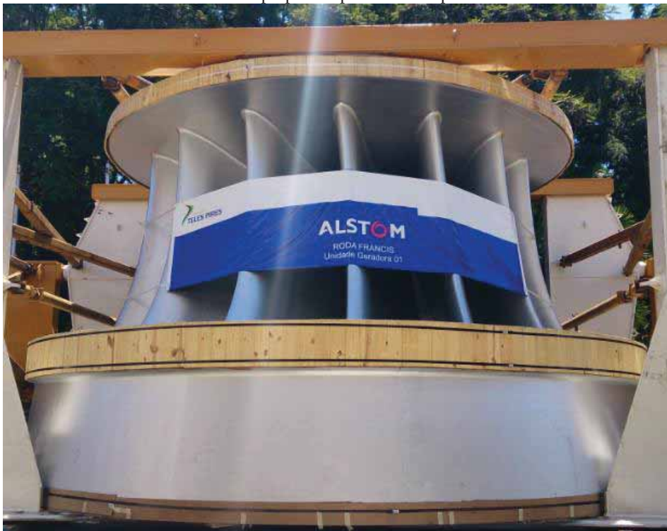
Figura 9 – Roda de uma turbina Francis sendo preparada para ser transportada.
