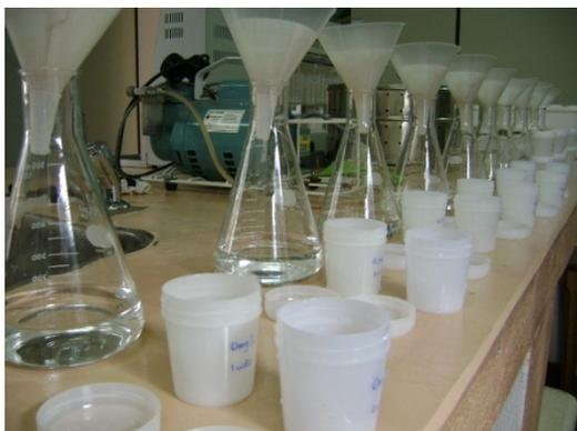
Figura 13: Filtração das Amostras
