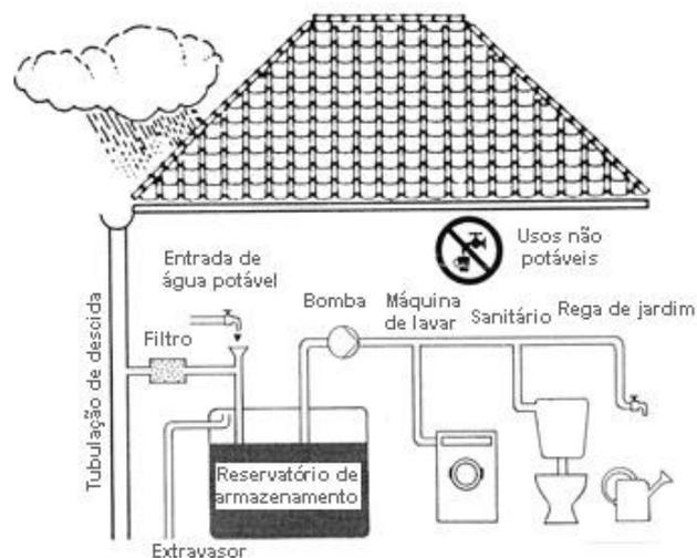
Figura 3: Captação de água pluvial por superfícies de telhados.
