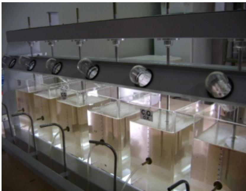
Figura 11: Adição simultânea de diferentes dosagens de solução de amido de milho
