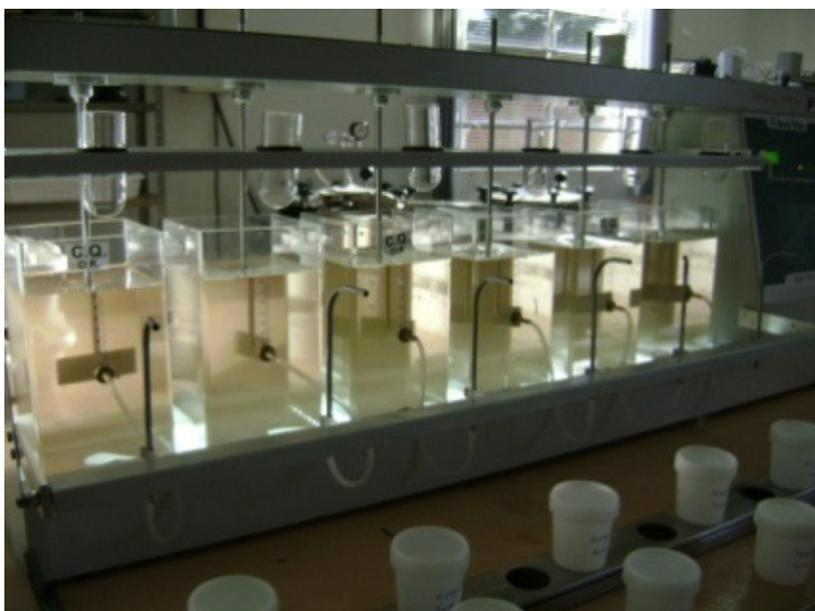
Figura 10: Homogeneização da água pluvial nos jarros do Jarreste
