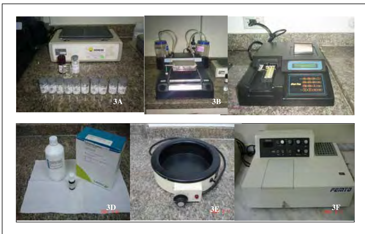
FIGURA 2 – Material e equipamentos utilizados para leitura de cortisol e glicemia: kit de cortisol e agitador (3 A), lavadora (3 B) e leitora de cortisol (3 C); kit de glicemia (3 D), banho Maria (3 E) e espectrofotômetro para leitura de glicemia(3 F) utilizados em experimento com girinos de R. catesbeiana
