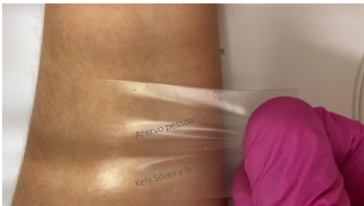
Figura 75: Potencial aplicação cosmética: adesão à pele úmida e elasticidade do filme 5,0% NFCB/Mn.
