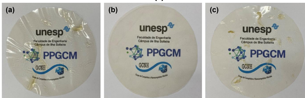
Figura 31: Aspecto visual dos filmes de alginato reticulados com: (a) \text{CaCl}_2 ; (b) \text{MnCl}_2 e (c) \text{AlCl}_3 .
