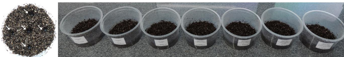
Figura 73: Disposição das sementes de feijão e do sistema completo no substrato em que as amostras foram degradadas durante 180 dias e germinação após 10 dias. Da esquerda para a direita: PEBD; Celulose; 0% NFCB; 0% NFCB/Mn; 5,0% NFCB; 5,0% NFCB/Mn e substrato controle.
