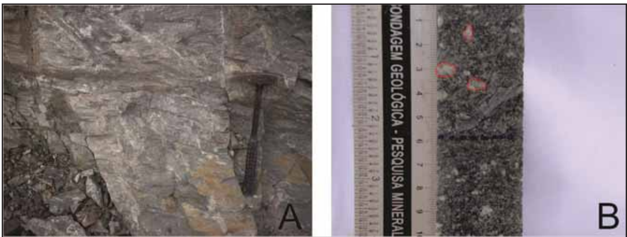
Figura 6.3- A) Afloramento de MAD compacto, esverdeado, de granulação fina, encontrado na cava do Canto 2, visada para sul, ponto 26. B) Amostra de MAD de testemunho de sondagem, com destaque em vermelho para fenocristais de albita e carbonato, furo FSS-1179.
