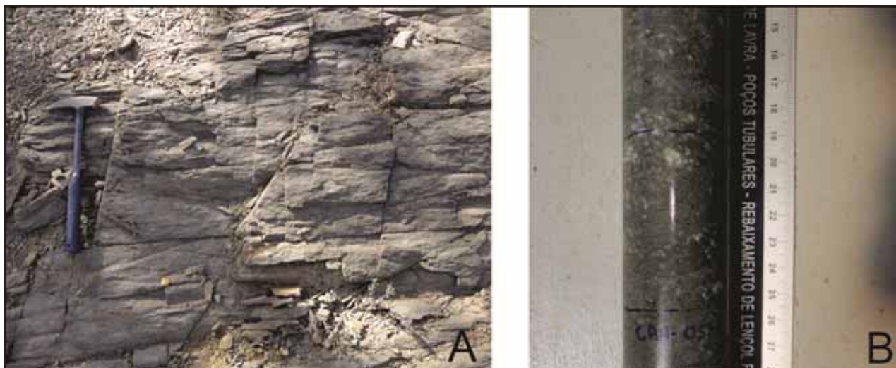
Figura 6.4- A) Afloramento em lagedo de metadacito, fraturado, maciço, com foliação bem marcada, visada para norte, ponto 299. B) Metadacito em amostra de sondagem rotativa, furo FWR-052, de granulação fina, maciço e coloração cinza esverdeada.
