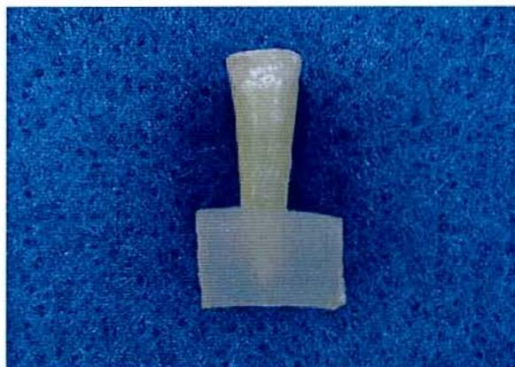
FIGURA 4 - Espécime após embutimento em resina acrílica.
