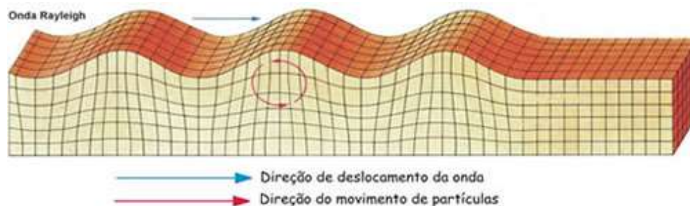
Figura 5 – Direção da vibração das partículas e do deslocamento da onda Rayleigh .
