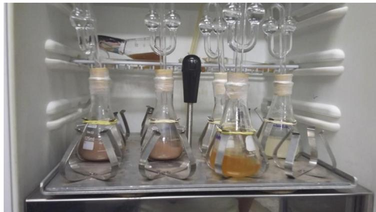
**Figura 12:** Meio sacarificado em estufa sob agitação acoplados a válvulas de anaerobiose.
