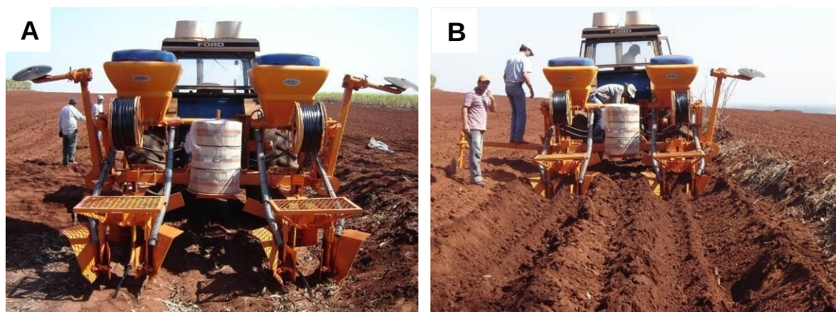
Figura 3. (A) Trator com sulcador de linha dupla e instalação simultânea do tubo gotejador. (B) Implemento durante a operação.
