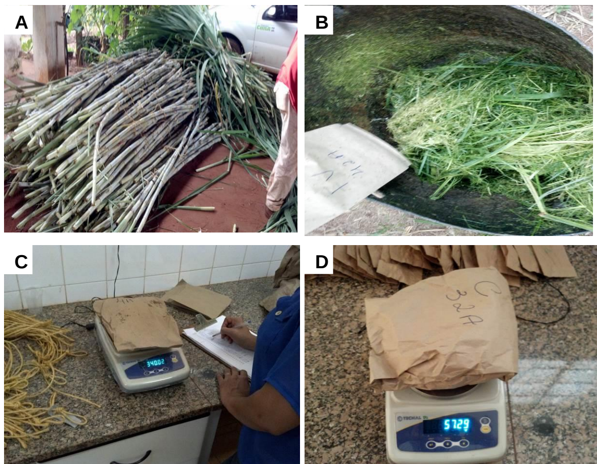
Figura 16. (A) Separação das diferentes partes, colmos e ponteiros, das amostras de parte aérea de cana-de-açúcar. (B) Amostra de ponteiro triturada em picadora de forragem. (C) Pesagem da sub-amostra fresca de colmo. (D) Pesagem da sub-amostra de colmo, após secagem em estufa à 65 °C.
