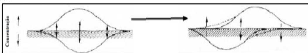
Figura 9 - Representação esquemática dos Efeitos de Transferência de Massas.
