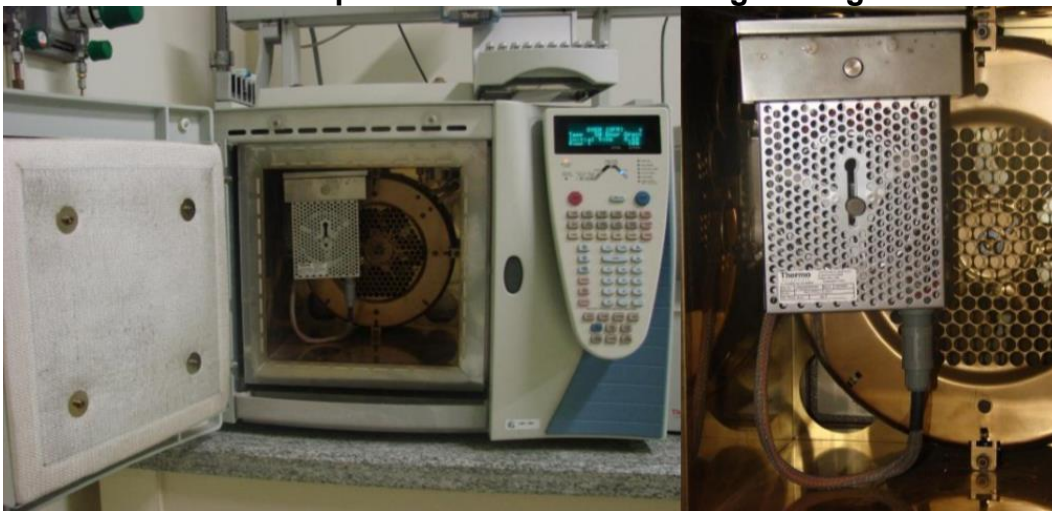
Figura 17 - Módulo ultrarrápido montado no cromatógrafo a gás utilizado.
