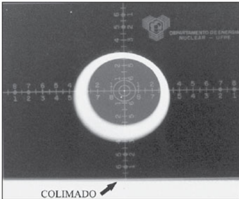
Figura 28 – Teste de exatidão do sistema de colimação. Imagem de coincidência de campos em conformidade.
