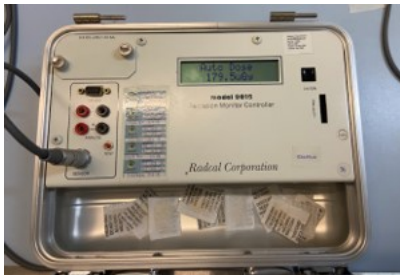
Figura 22 – Eletrômetro da câmara de ionização de uso do Hospital das Clínicas da Faculdade de Medicina de Botucatu (HCFMB).
