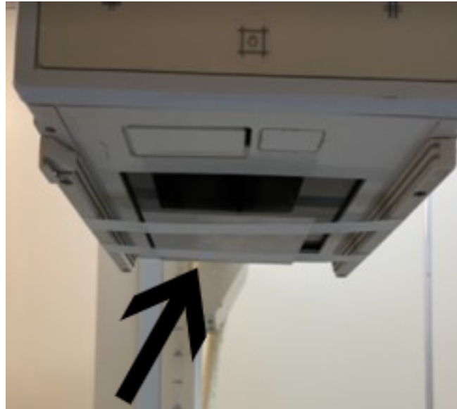
Figura 21 – Placas de alumínio para atenuação do feixe no teste de camada semi-redutora em um raio-X localizado no Hospital das Clínicas da Faculdade de Medicina de Botucatu (HCFMB).
