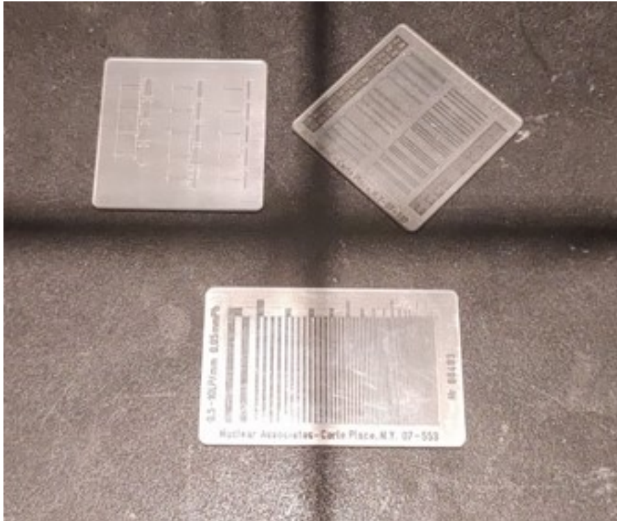
Figura 35 – Análise da quantidade de pares de linha por milímetro (pl/mm) usando placas de chumbo de modelos: 07-527, 07-553 e 07- 548 realizado no Hospital das Clínicas da Faculdade de Medicina de Botucatu (HCFMB).
