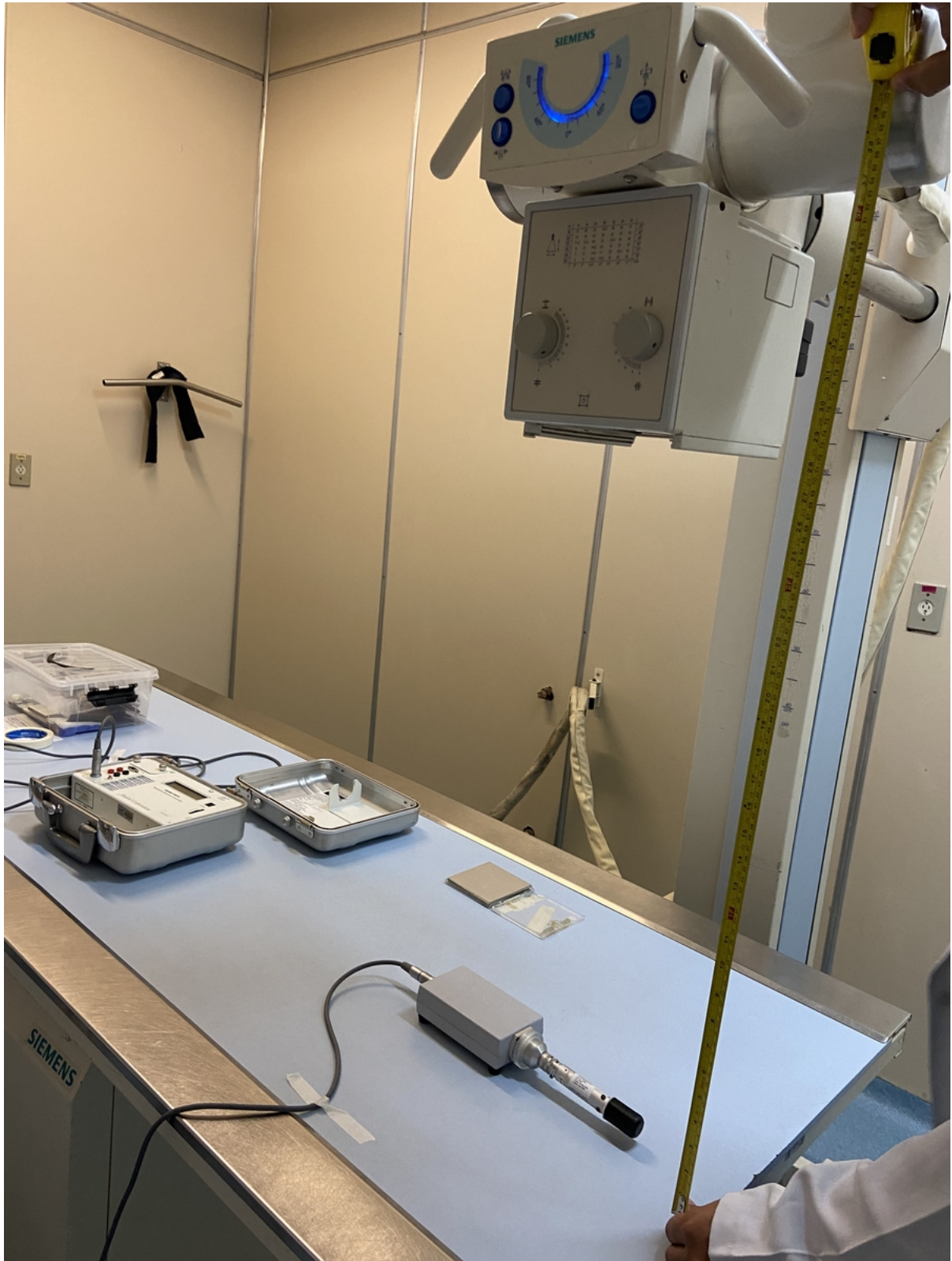
Figura 19 – Teste de exatidão dos indicadores da distância foco-receptor em um raio-X localizado no Hospital das Clínicas da Faculdade de Medicina de Botucatu (HCFMB).
