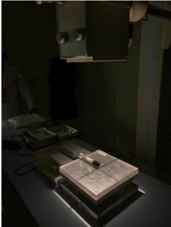
Figura 34 – Teste de valores representativos de dose com a câmara de ionização sobre o fantoma realizado no Hospital das Clínicas da Faculdade de Medicina de Botucatu (HCFMB).
