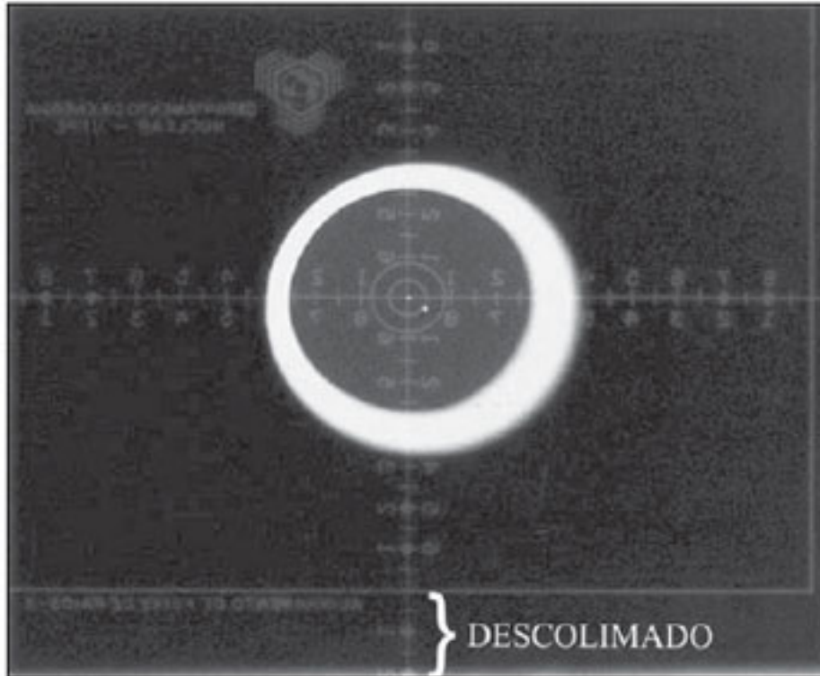
Figura 27 – Teste de exatidão do sistema de colimação. Imagem de coincidência de campos em desacordo.
