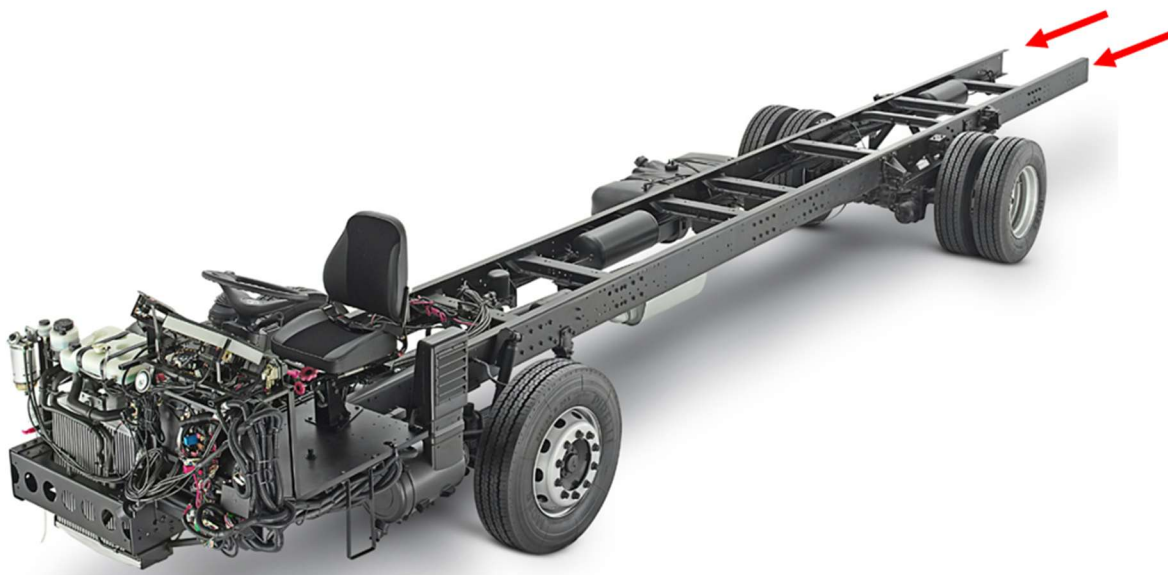
Figura 3: Longarinas montadas no chassi de um ônibus ou caminhão
