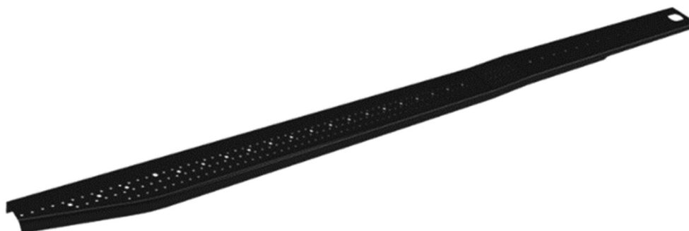
Figura 3: Longarinas montadas no chassi de um ônibus ou caminhão
