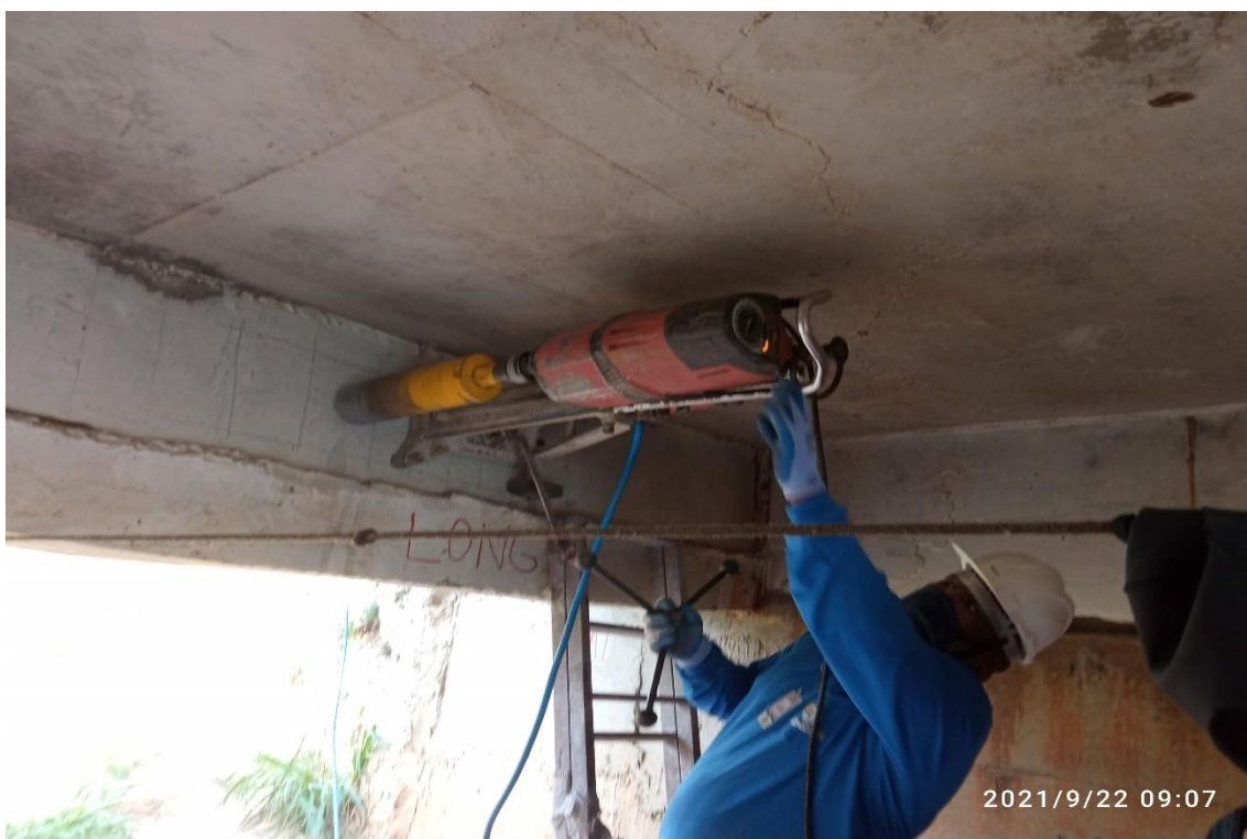
Figura 3.8: Acoplamento do cálice e da coroa diamantada na extratora, para posterior retirada do testemunho (SMO, 2022).
