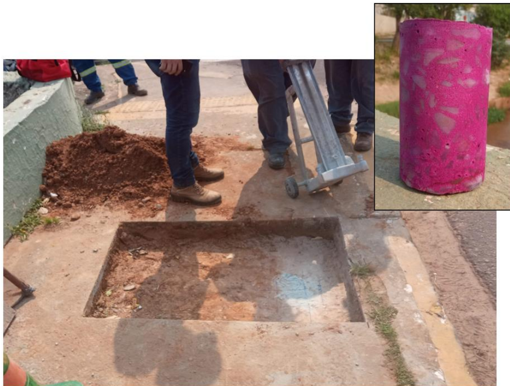
Figura 3.13: Ao fundo apresenta a localização das extrações dos testemunhos CP's 05 e 06. Em destaque apresenta CP extraído sem carbonatação (modificado de SMO, 2022).
