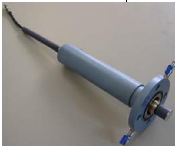
Figura 2.8- Sensor UHF utilizado para detectar DPs.
