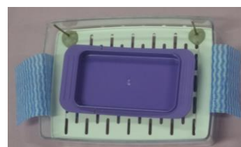
Figura 4. Cubo de eletroforese finalizado contendo suporte (manteigueira azul) para gel.
