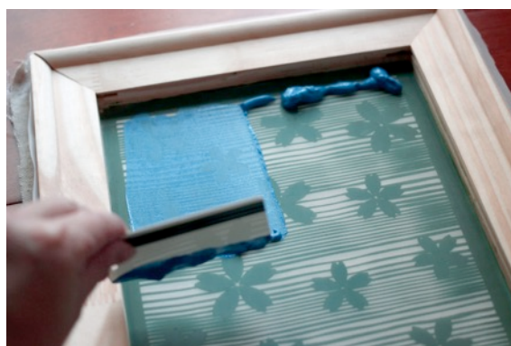
Figura 188 (esq.) – Processo serigráfico. Material necessário para a estampar. (OMOTO, 2015)
