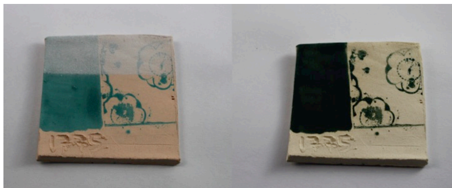
Figura 161 – Processo Pigmentação. Exemplo de cor que a tonalidade ficou melhor em baixa temperatura. (OMOTO, 2014)
