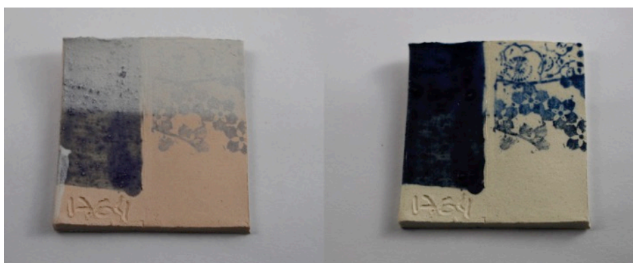
Figura 160 – Processo Pigmentação. Exemplo de cor que apareceu em alta temperatura (1240°C). (OMOTO, 2014)
