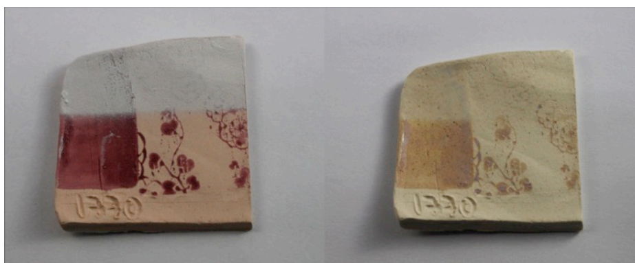
Figura 159 – Processo Pigmentação. Exemplo de cor que perdeu a tonalidade na alta temperatura (1240°C). (OMOTO, 2014)
