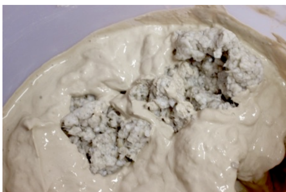
Figura 165 (esq.) – Processo Paperclay. Polpa e porcelana líquida. (OMOTO, 2015) Figura 166 (dir.) – Processo Paperclay. Barbotina paperclay. (OMOTO, 2015)
