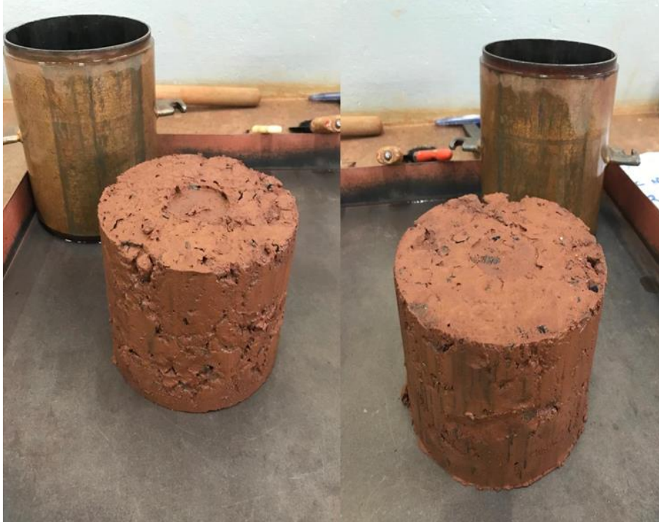
Figura 24 – Detalhe da dosagem com 75% de escória de aciaria e brita 1.
