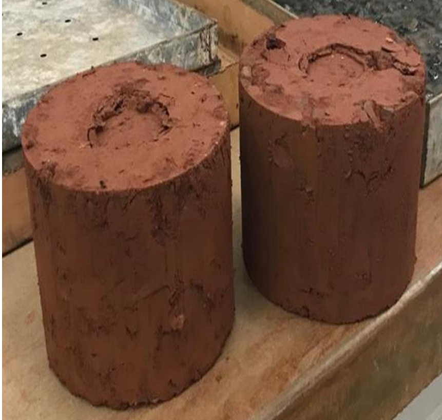
Figura 22 – Detalhe da dosagem com 65% de escória de aciaria e brita 1.
