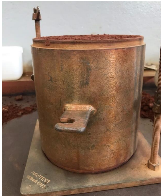
Figura 14 – Detalhe do arrasamento.
