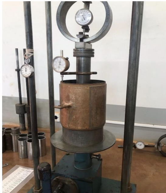
Figura 9 – Análise da penetração no Ensaio CBR.
