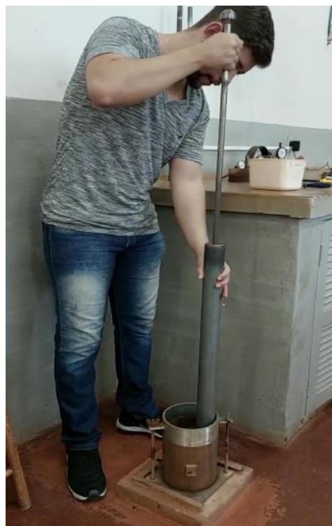
Figura 11 – Compactação do corpo-de-prova.
