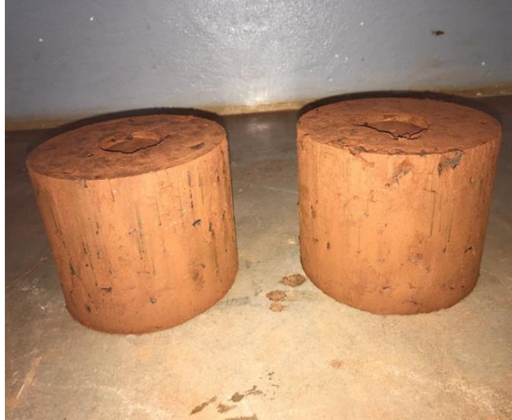
Figura 20 – Dosagem com 55% de escória de aciaria e brita 1.
