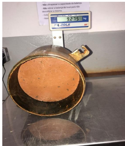
Figura 17 – Pesagem do corpo-de-prova + molde.
