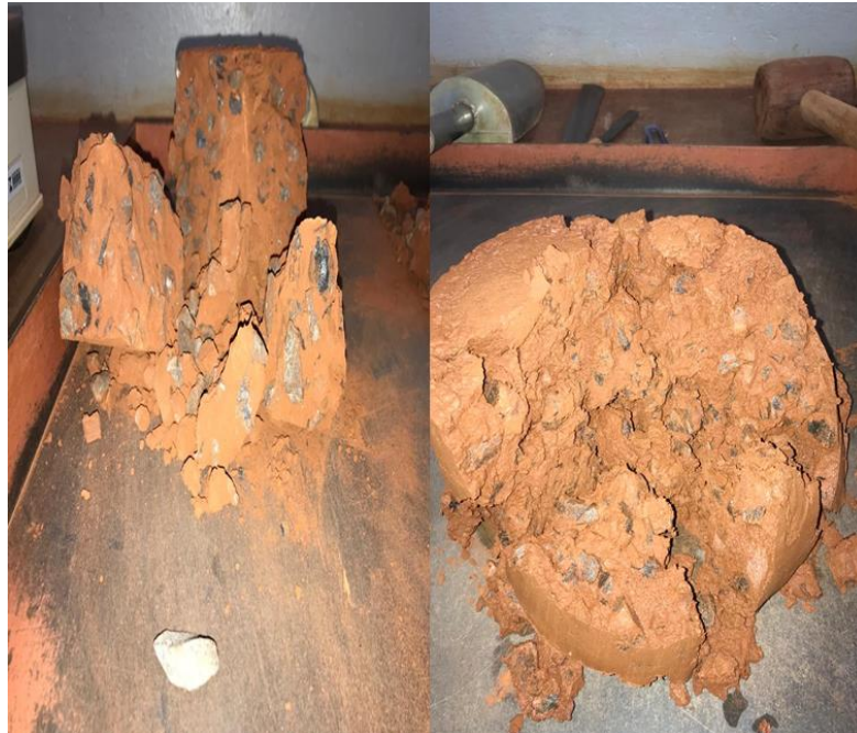
Figura 21 – Detalhe da dosagem com 55% de agregado.
