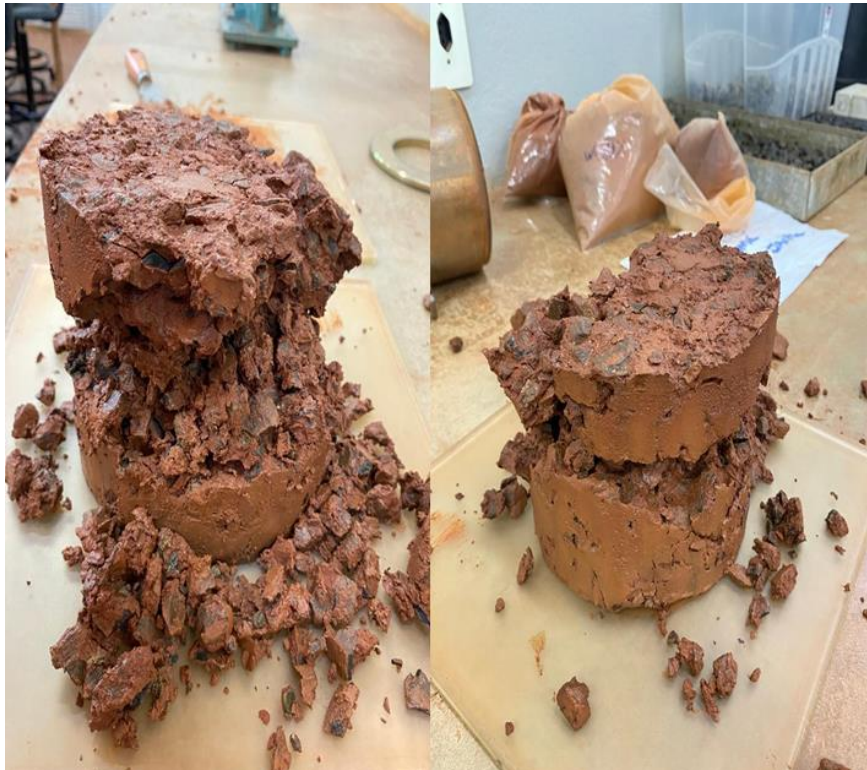
Figura 25 – Detalhe da dosagem com 75% de agregado.
