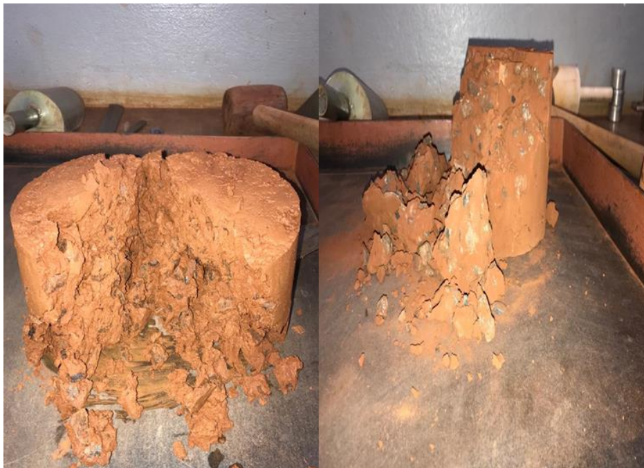
Figura 23 – Detalhe da dosagem com 65% de agregado.
