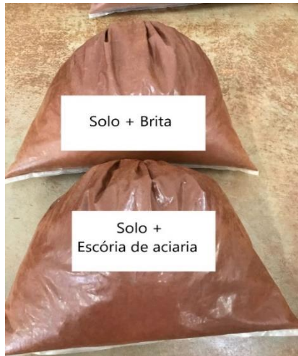
Figura 10 – Mistura estabilizada do solo-agregado.
