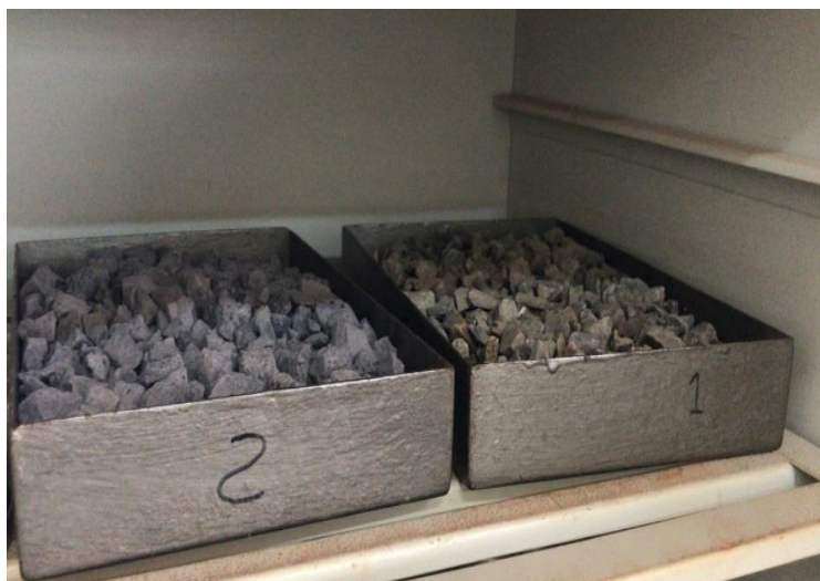
Figura 7 – Agregados submetidos a estufa para secagem, agregado artificial à esquerda e britado à direita.
