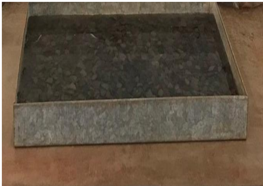
Figura 5 – Imersão do agregado britado.
