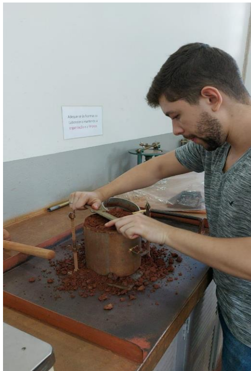
Figura 13 – Arrasamento dos corpos-de-prova compactados.
