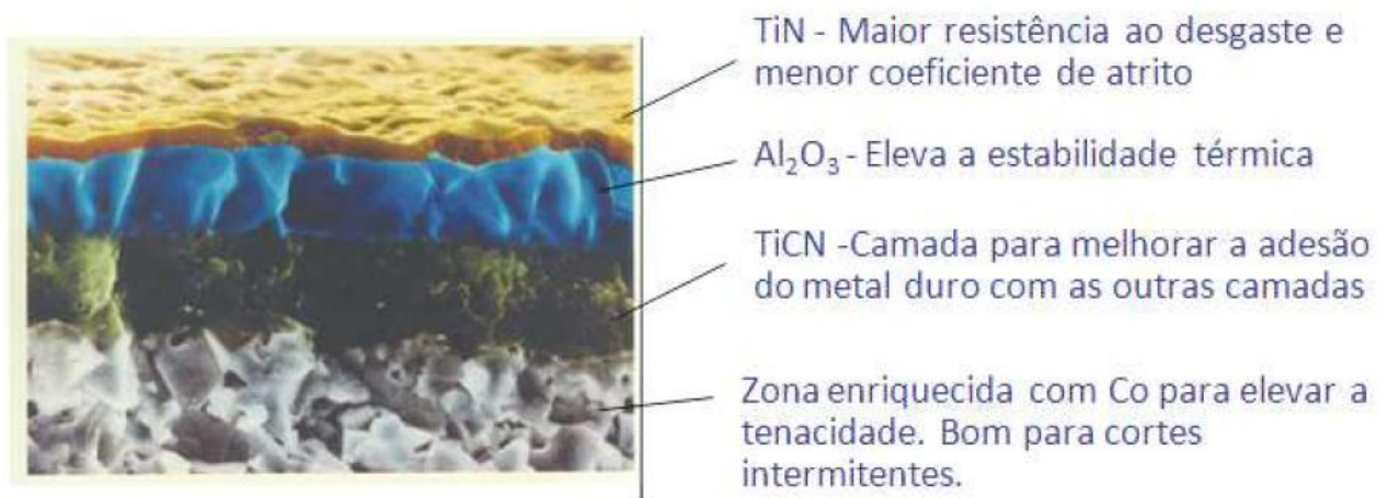
Figura 16 – Fotografia de um revestimento múltiplo de metal duro obtida por MEV
