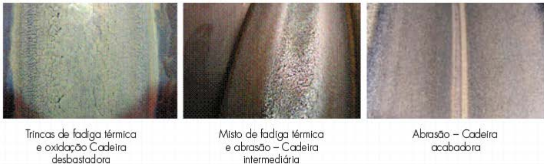
Figura 3 Superfície típica de desgaste de cilindros após laminação num laminador de longos contínuo de 15 cadeiras.
