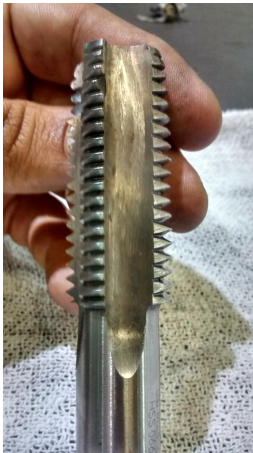
Fotografia 2 – Macho modificado com os canais esmerilhados
