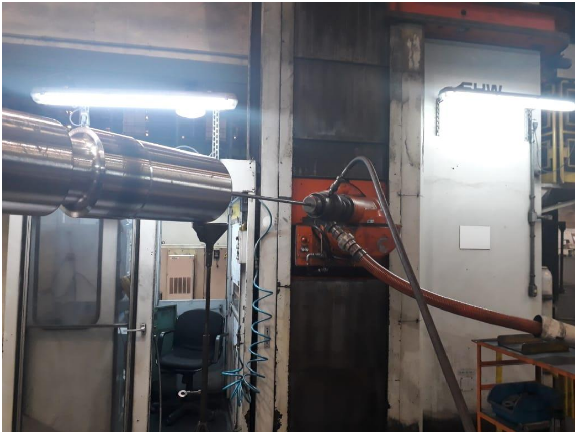
Fotografia 3 – Mandriladora horizontal SHW realizando operação de furação
