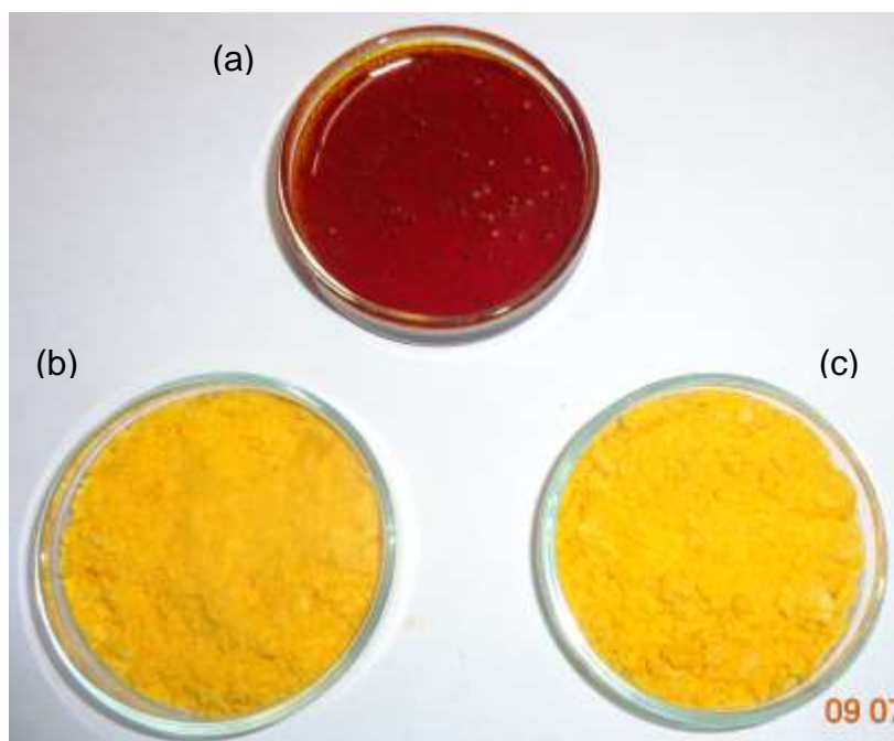
Figura 21. Aspecto visual do azeite de buriti (a), e cápsulas de alginato:WPC (b) e pectina:WPC (c).
