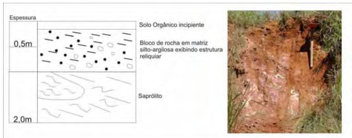
Figura 14 – Perfil de alteração típico da Sub-Unidade III-B.
