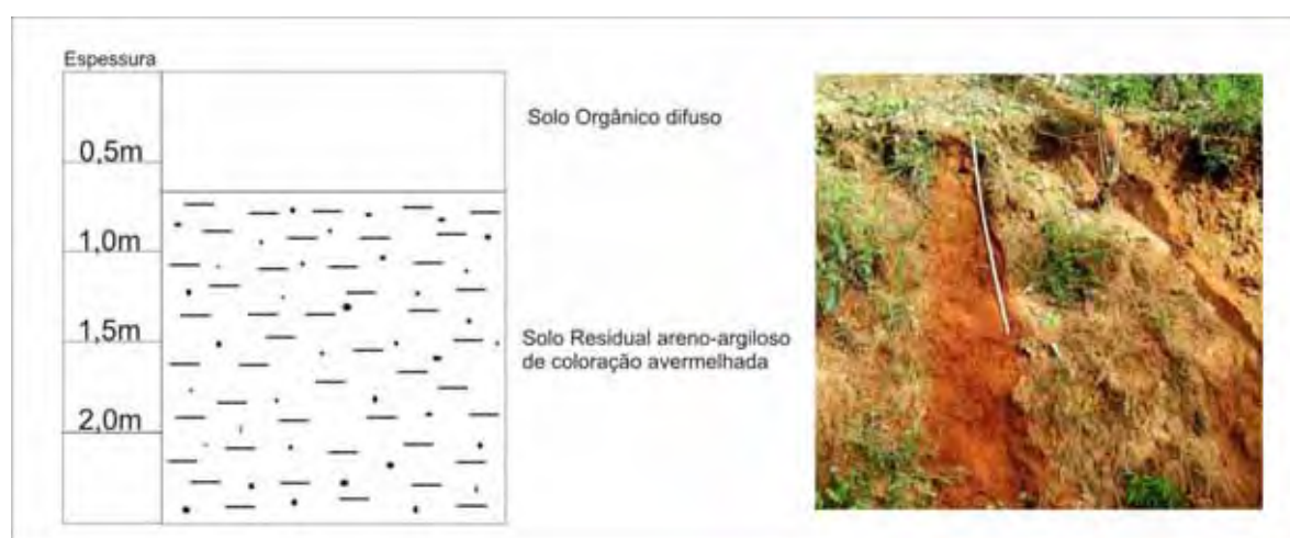
Figura 16 – Perfil de alteração típico da Unidade V.
