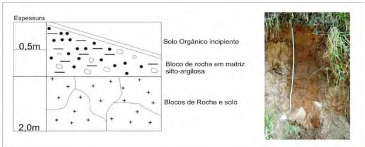
Figura 12 – Perfil de alteração típico da Sub-Unidade II-B.
