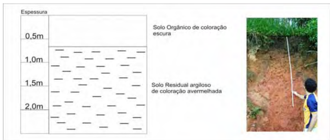
Figura 13 – Perfil de alteração típico da Sub-Unidade III-A.
