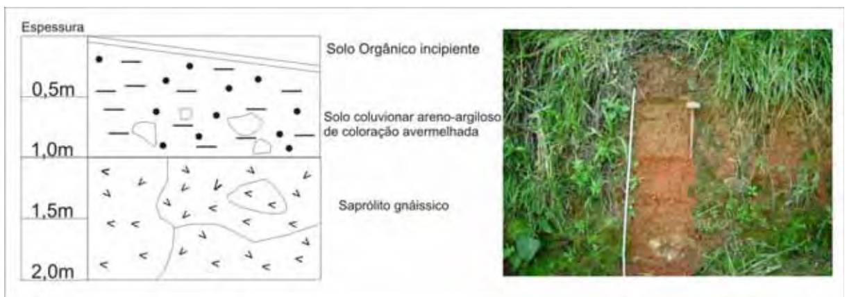
Figura 18 – Perfil de alteração típico da Sub-Unidade VI-B.
