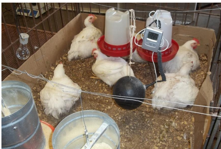
Figura 5 – Termômetro para mensuração da temperatura do ar e umidade relativa, e globo negro com termopar inserido para mensuração da temperatura
