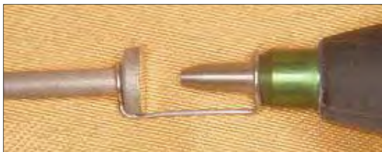
FIGURA 6: Dispositivo construído com fio ortodôntico (0,7 mm) para padronização da distância de jateamento.
