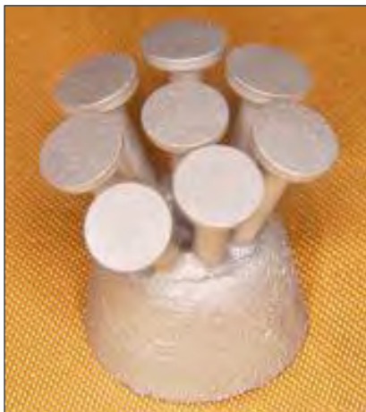
FIGURA 4: Estruturas metálicas unidas ao conduto de alimentação.
