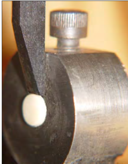
FIGURA 10: Cinzel posicionado para realização do cisalhamento.
