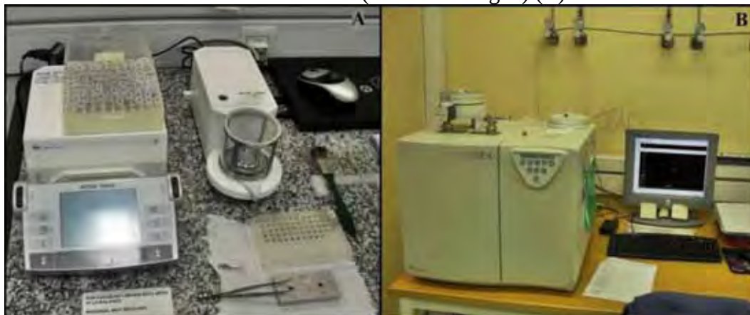
Figura 44 - Microbalança MX-5 (Mettler-Tolledo) com precisão de 1 \mu g (A); analisador elemental Flash EA 1112 (ThermoFinnigan) (B).
