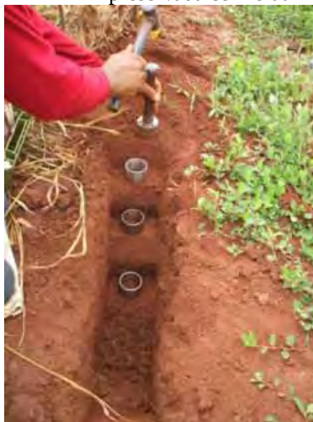
Figura 3 - Coleta de amostras de solo com sua estrutura preservada com o auxílio do anel de Kopeck.
