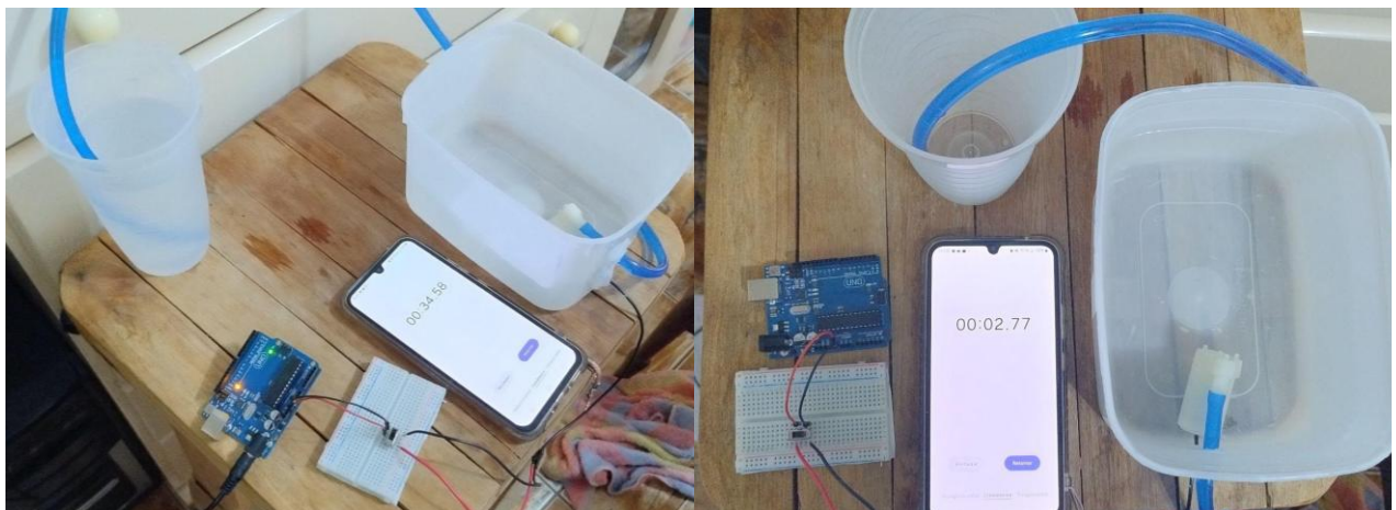
Figura 43 – Teste de vazão da bomba d'água.
