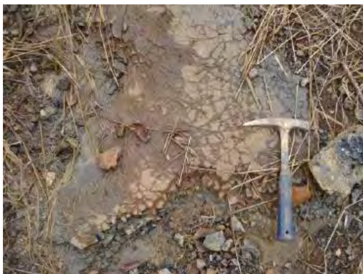
Figura 13: Fotografia mostrando o fluxo da escória cristalizada no chão, e também como brita.
