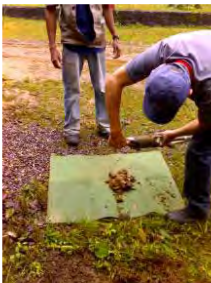
Figura 12: Técnica de amostragem utilizada para a coleta de solos, utilizando-se trado manual tipo “caneco” e lona.
