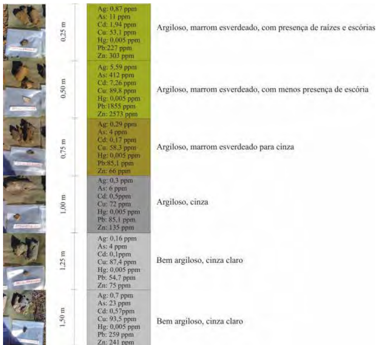
Figura 18: perfil do Furo Mestre JM-L-FMA, com valores dos elementos e as fotos realizadas durante a coleta para cada intervalo.
