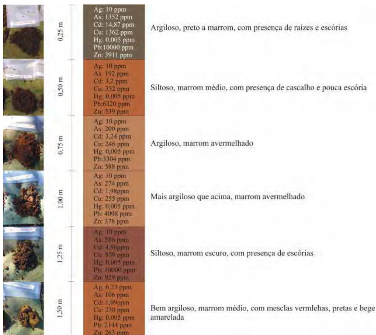
Figura 20: perfil do Furo Mestre JM-L-FMB, com valores dos elementos e as fotos realizadas durante a coleta para cada intervalo.
