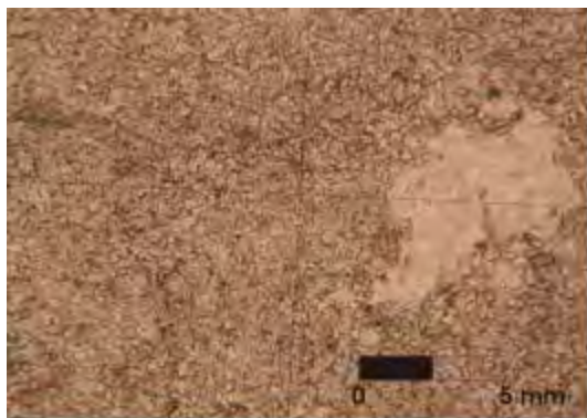
Figura 30: Foto micrografia da lâmina JM-R-09, com granulação muito fina a densa, onde é possível observar apenas cristais de quartzo, anfibólio e epidoto. Respectivamente, nicóis // e x .
