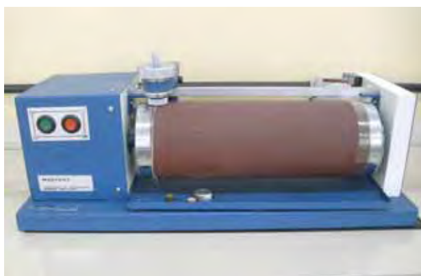
Figura 13: Abrasímetro utilizado para realização da técnica de resistência abrasão.
