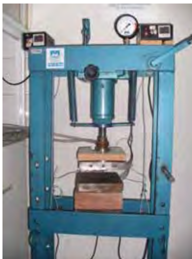
Figura 7: Prensa termoeletrica utilizada para obtenção dos compósitos BN/Couro com controle de temperatura.
