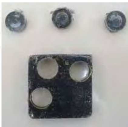
Figura 14: Corpos de prova utilizados para realização da técnica de resistência à abrasão.
