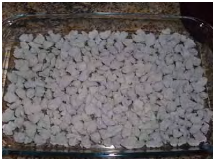
Figura 5: Mistura de borracha natural com raspa de couro após tratamento térmico.
