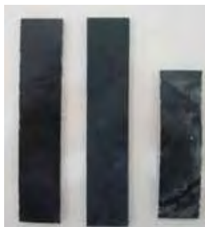
Figura 12: Corpos de prova utilizados para realização da técnica de resistência à quebra da flor
