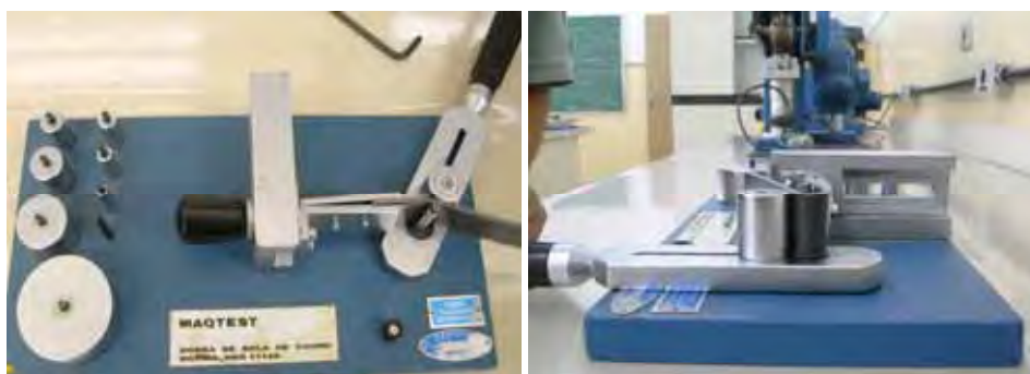
Figura 11: Dobrômetro utilizado para realização da técnica de resistência de quebra da flor.
