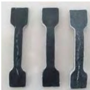
Figura 10: Corpos de prova utilizados para realização da técnica de ensaio mecânico
