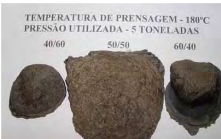
Figura 9: Foto dos compósitos BN/Couro prensados sob a carga de 5 toneladas na temperaturas de 180°C
