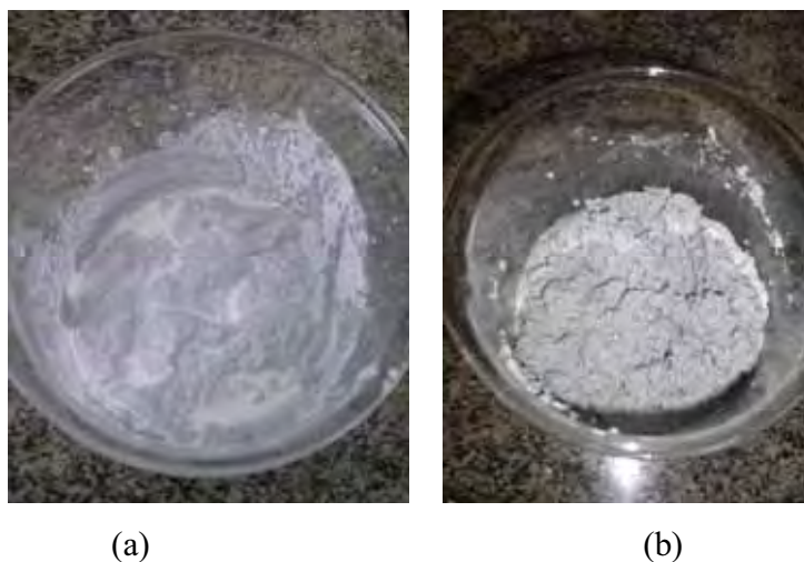
Figura 4: Mistura entre solução de couro e látex antes da adição da solução de ácido acético (a) e após a adição da solução de ácido acético (b).
