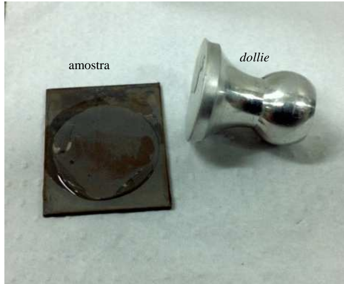
Figura 3.2. Amostra e dollie após teste de adesão.
