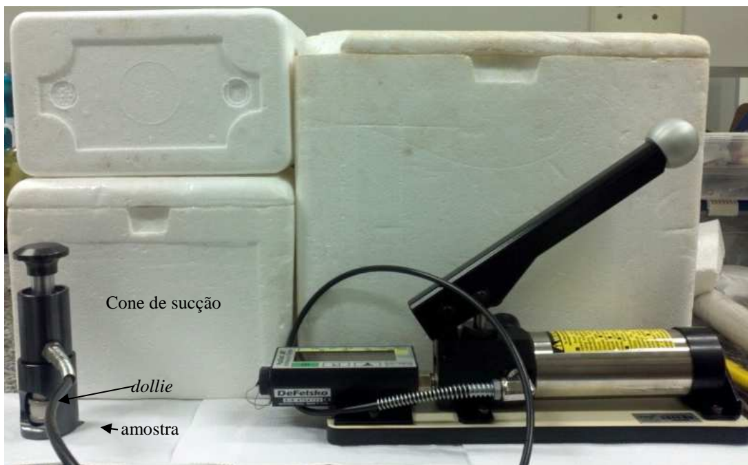
Figura 3.1. Equipamento pull off para teste de adesão de recobrimento.
