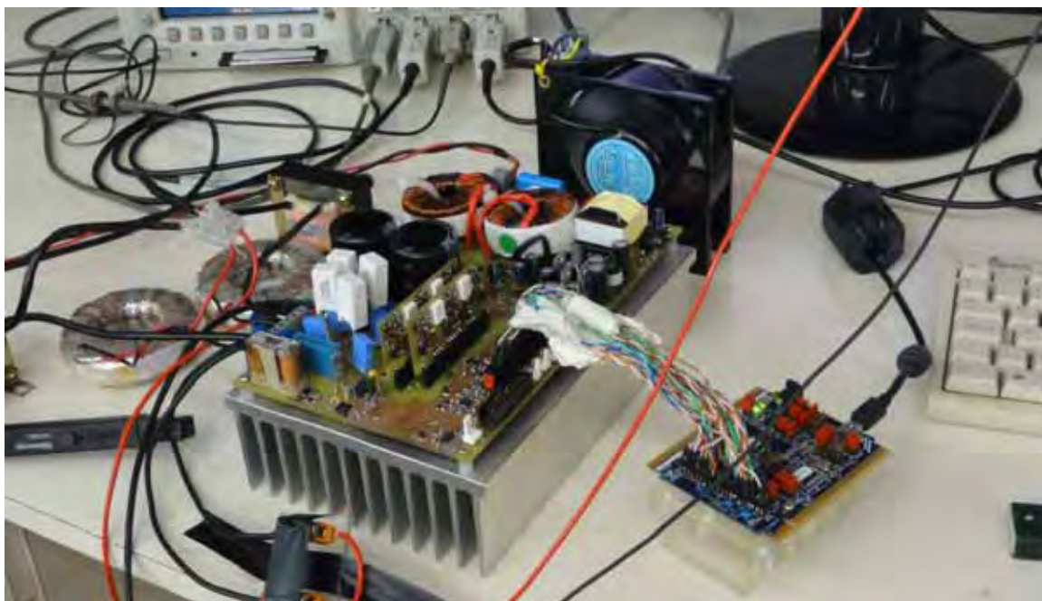
Figura 152- Detalhe do Conversor e da placa DSC.
