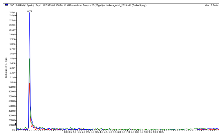
Figura 8 – Cromatograma obtido para o glyphosate (50 L -1 )
