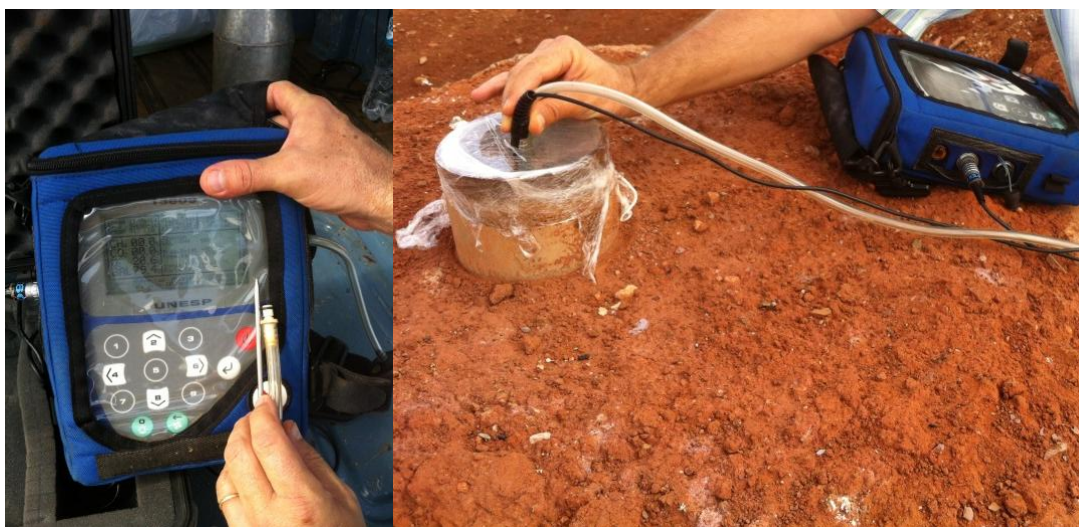
Figura 12: Análise qualitativa do biogás do aterro de Rio Claro (SP) com a utilização do instrumento portátil LANDTEC GEM-2000.
