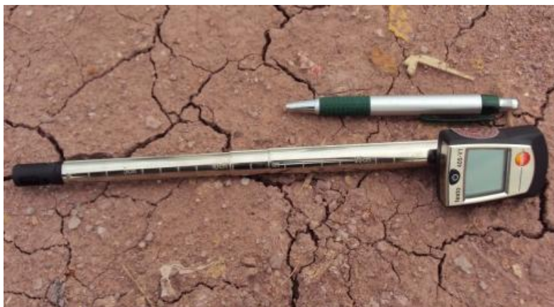
Figura 10: Termo anemômetro digital portátil TESTO, modelo 405-V1 utilizado nas expedições a campo. Fonte: ANTONIO (2012).
